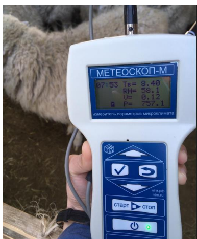
Рисунок 13 – Универсальный измеритель параметров микроклимата - МЕТЕОСКОП-М
