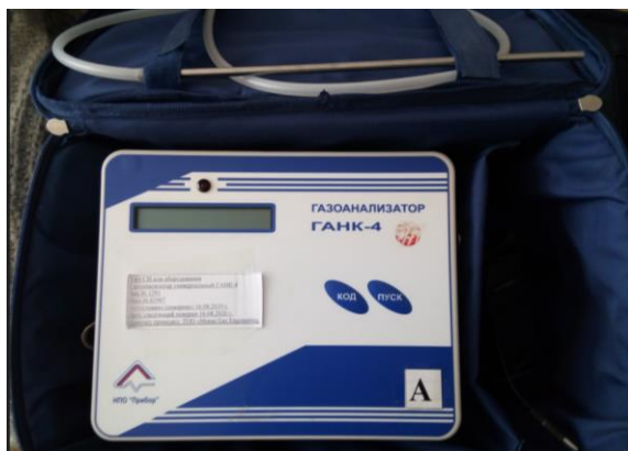
Рисунок 12 – Универсальный газоанализатор ГАНК -4
