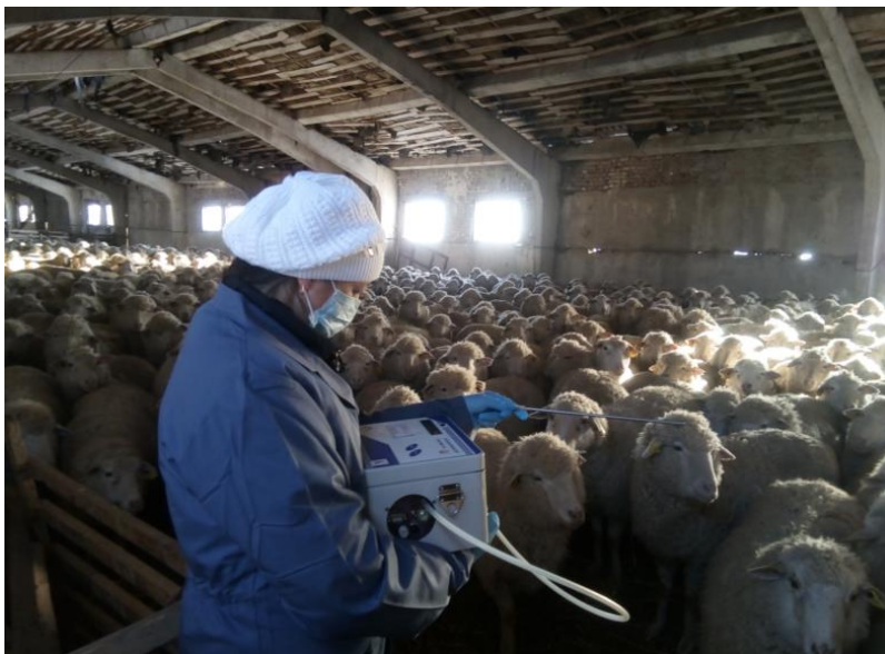
Рисунок 27- Измерение газового состава кошар газоанализатором ГАНК-4 КПКУ 413322 002
