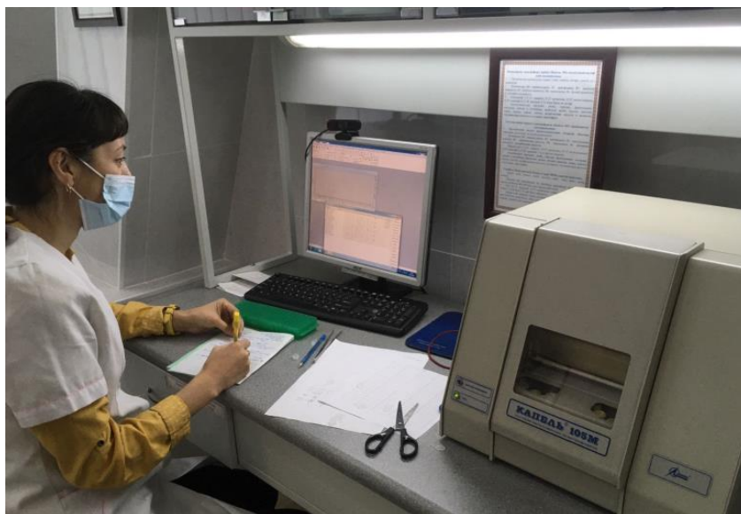
Рисунок 58 - Определение аминокислот на аппарате «Капель-105 М»
