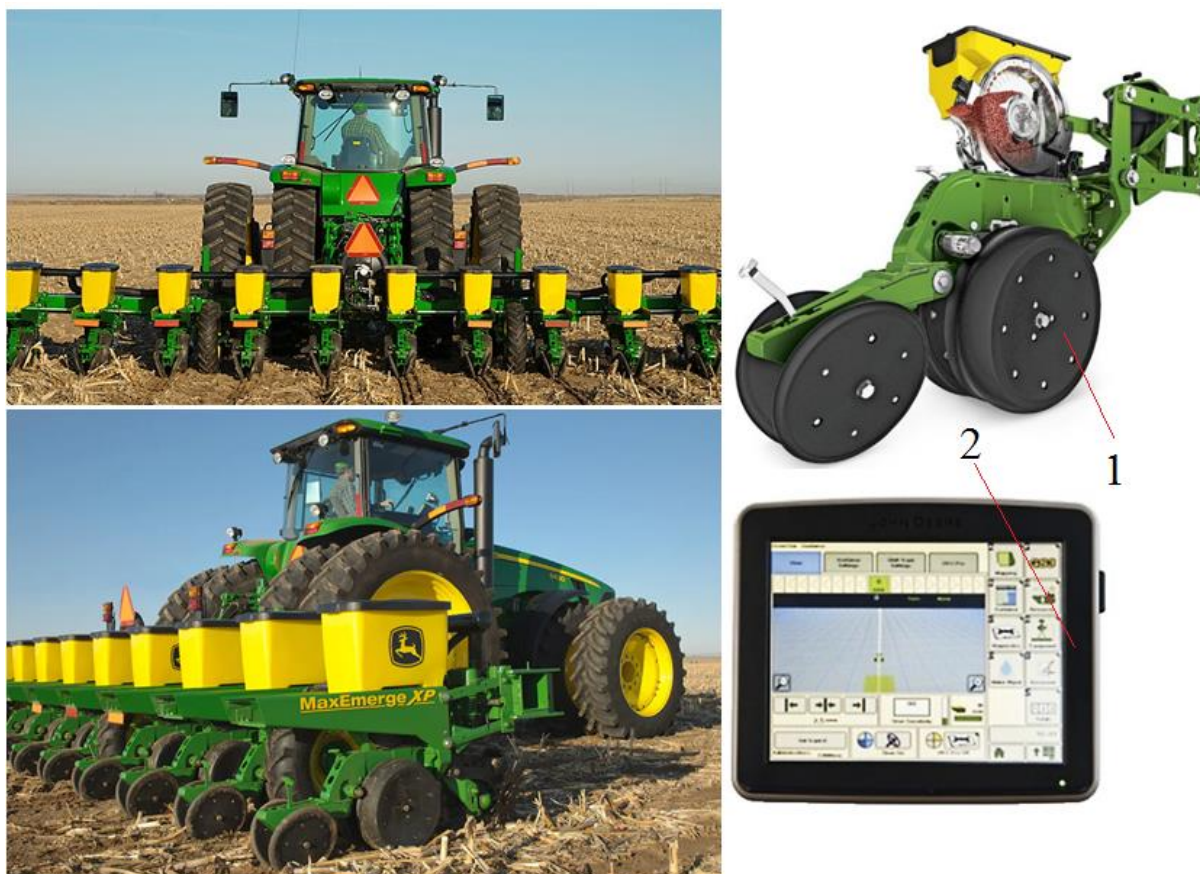
Сурет 4.5 – Дәлдікпен егетін 1715 John Deere сепкіші: 1 – сепкіш секция MaxEmerge 5; 2 – дәлдік егіншілік жүйесінің барлық қосымшаларына арналған монитор – SeedStar 2 мониторинг жүйесі.
