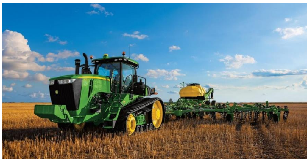
Сурет 2.12 – John Deere XXL 9R қуатты тракторымен агрегатталатын топырақ өңдеу және тыңайтқыш енгізу кешені
