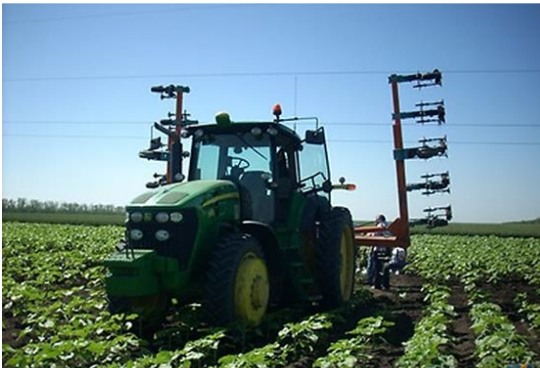
Сурет 6.2 – Отамалы дақылдардың қатар аралықтарын культиватормен өңдеу
