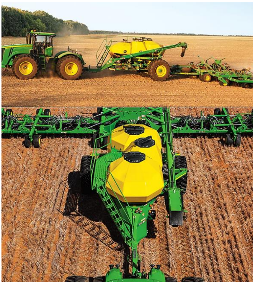
Сурет 2.15 – Топырақ өңдейтін әрі тұқым себетін бір дискілі пневматикалық кешен John Deere 1890
