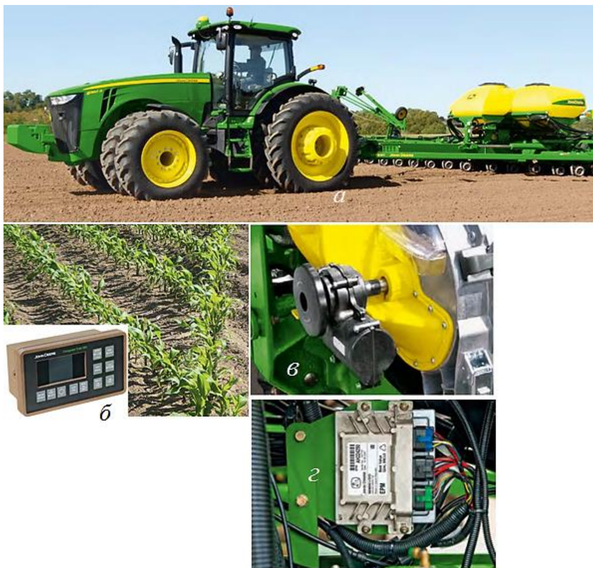
Сурет 4.28 – Секцияларды басқару RowCommand жүйесі: а – тұқым себу кешені; б – COMPU TER-TR АК дисплейі; в – Pro-Shaft жетек редукторы; г – электрондық қоректендіру блогы.
