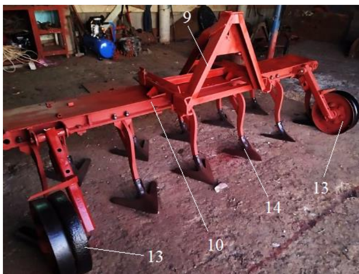
Сурет 2.5 – Гидрофикацияланған баулық КСГ-5 культиваторының ортаңғы секциясы: 9 – асқыш құрылғы; 10 – ортаңғы секция; 13 – доңғалақтары; 14 – сүйір табан.
