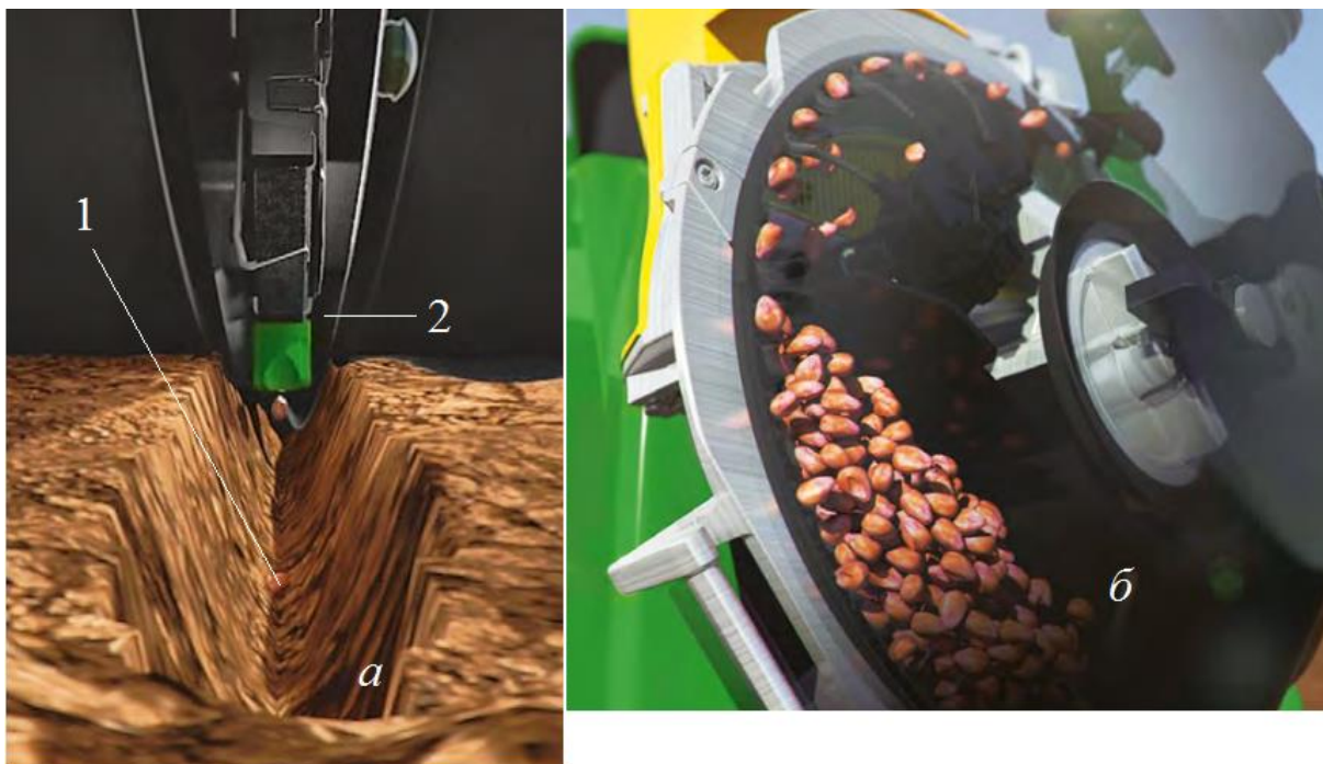
Сурет 4.24 – Ленталы щеткамен беріс жүйесі және өнімділігі жоғары вакуумметр: а – қарықта тұқымдардың түсуі; б – дозатор; 1 – қарықтағы тұқым; 2 – дискілі сіңіргіш.
