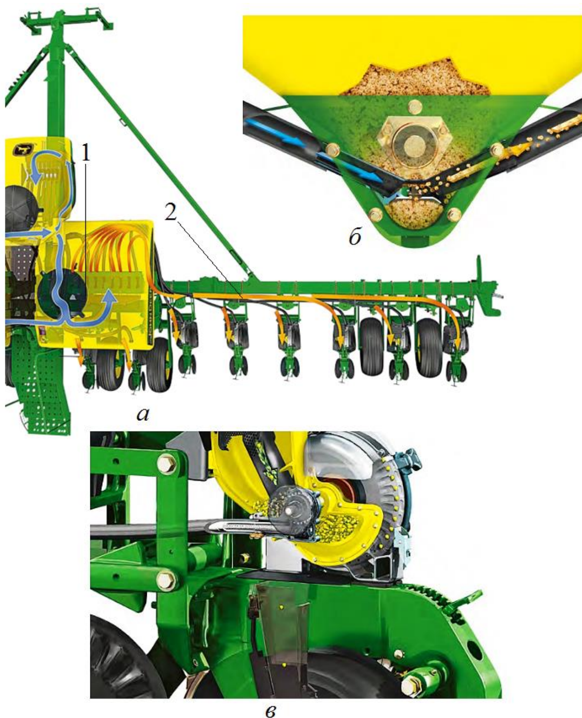
Сурет 4.27 – John Deere 17 75NT егістік кешені агрегаттары: а – себу секциялары; б – гидрожетегі бар желдеткіштен шығатын ауа тасқыны; в – тұқым өткізетін түтік толғанша бак себілетін тұқыммен толтырылады; 1 – бак; 2 – себу секцияларына жалғанған түтіктер.
