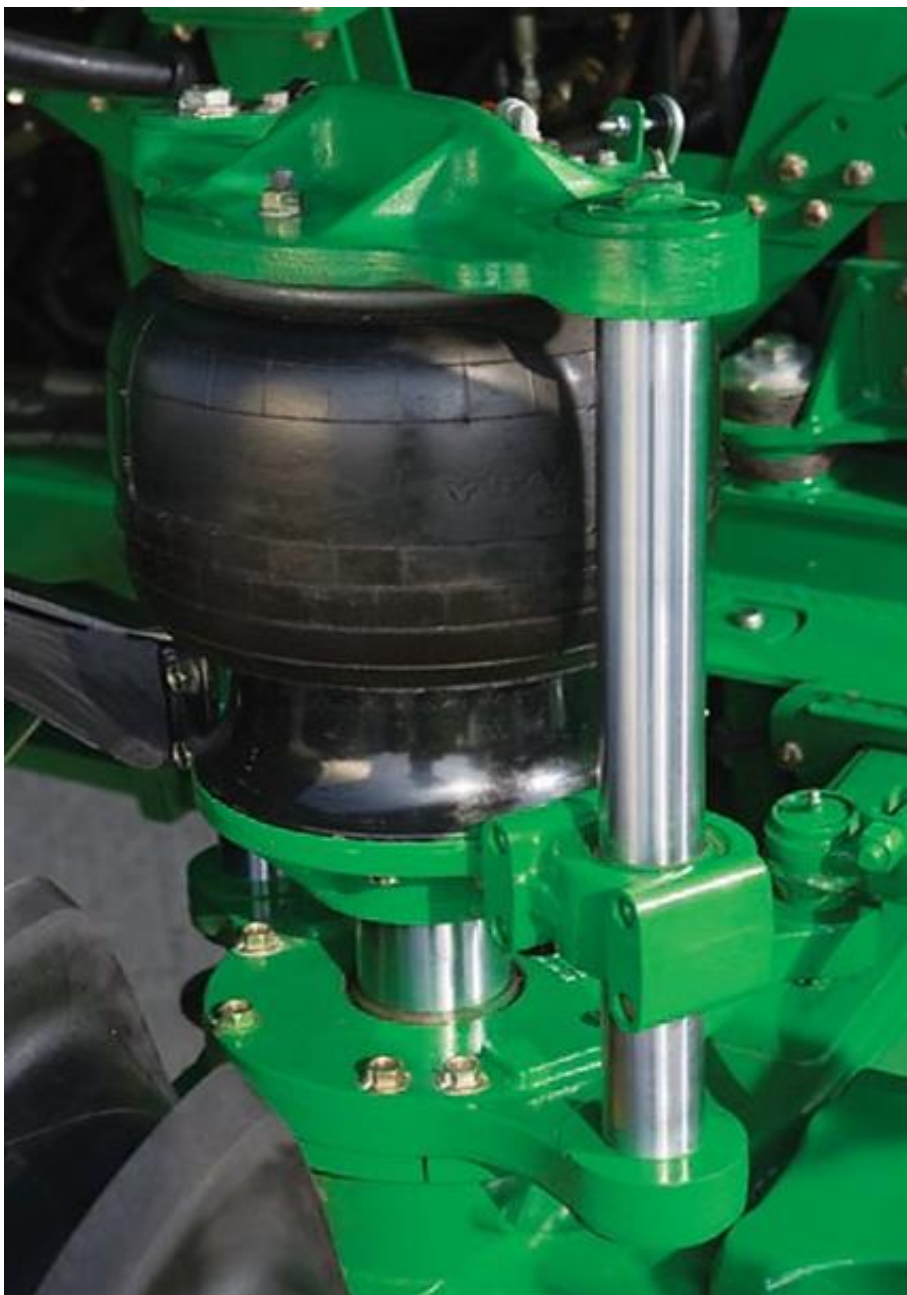
Сурет 7.13 – Тәуелсіз пневматикалық төртдоңғалақты асқыш
