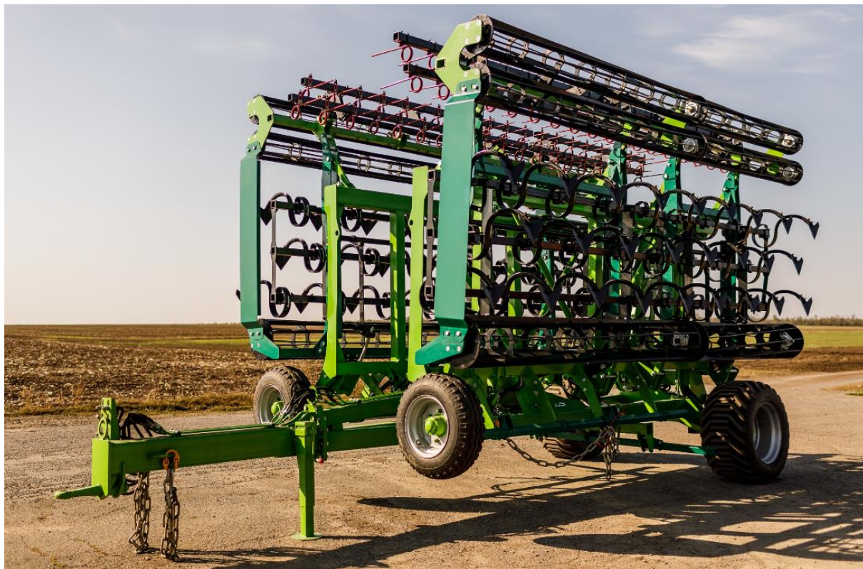
Сурет 2.13 – Кеңістіктегі параллелограмм түріндегі механизмдер көмегімен жалғанған топырақ өңдеу кешені
