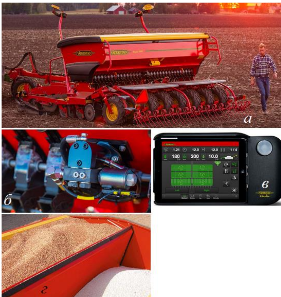
Сурет 4.32 – Rapid 300-400C/S тұқым сепкіш машинасы: а – BioDrill себу машинасы; б – тұқымдар мен тыңайтқыштарды гидравликалық мөлшерлеу; в – Väderstad E-Control жүйесі; г – тұқымға және тыңайтқышқа арналған бункер.
