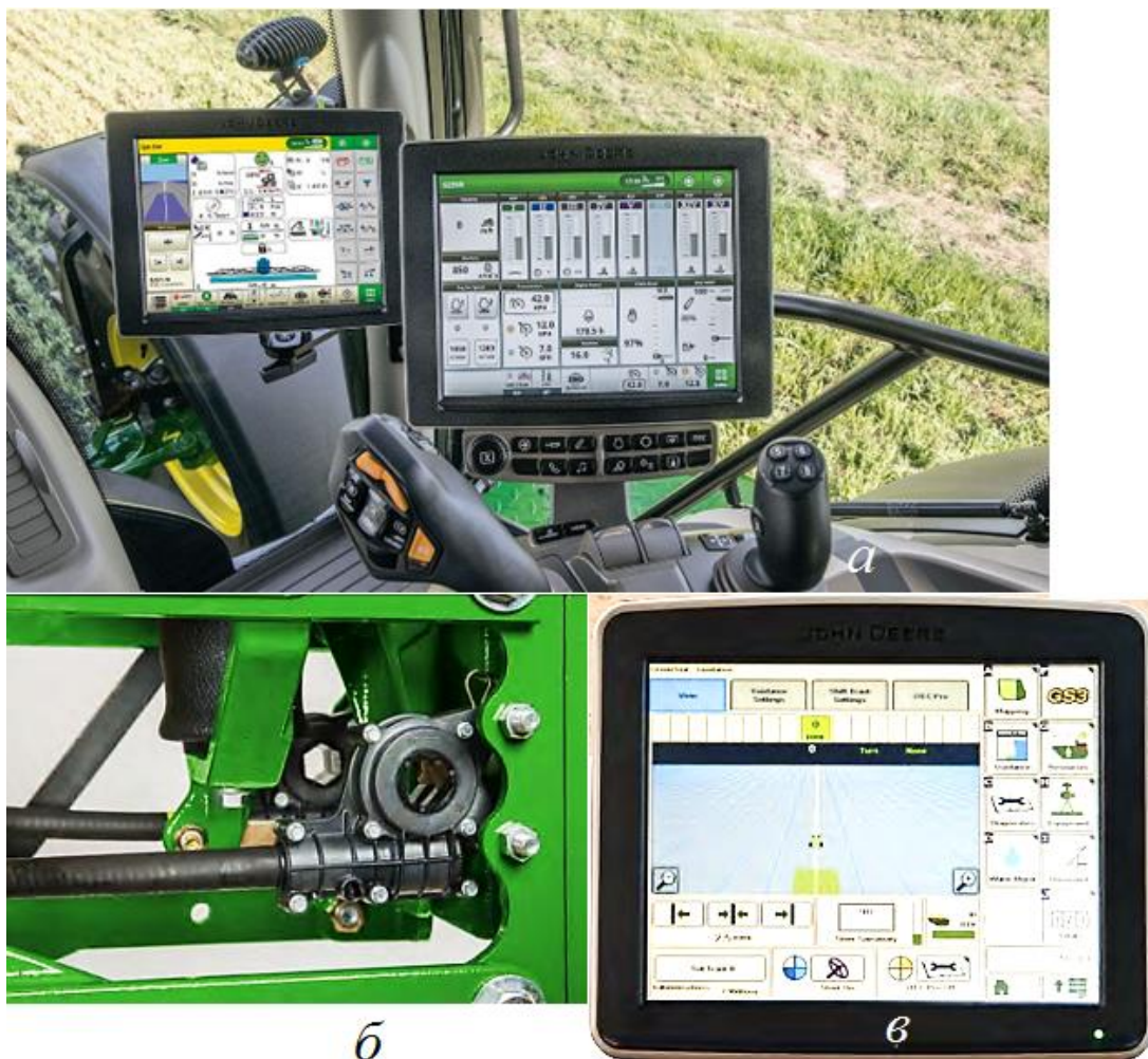
Сурет 4.29 – Дәлдік (AMS) егіншілік жүйелерінің мониторы: а – тұқымдардың себілуін бақылау; б – RowCommand жүйесіндегі Pro-Shaft жетегі; в – монитор
