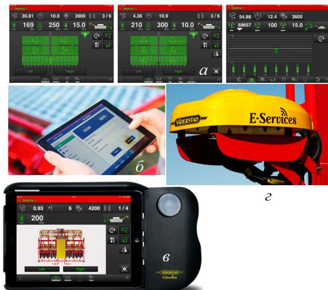
Сурет 4.33 – Väderstad E-Control жүйесі: а – заманауи сымсыз Väderstad E-Control бақылау жүйесі; б – бақылаудың портативтік жүйесі; в – iPad арналған E-Keeper ұстаушысы; г – маршрутизатор
