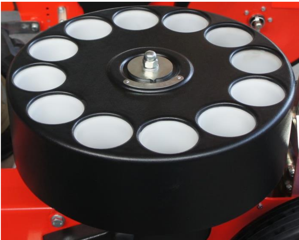
Сурет 5.12 – 12 стаканға есептелген айналмалы таратқыш
