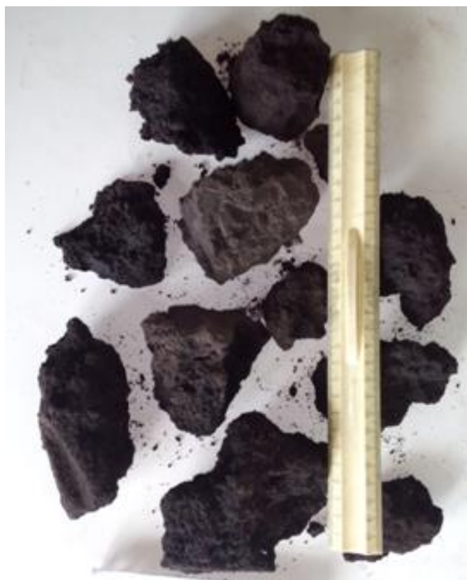
Рисунок 37 – Измерение частиц размером более 50 мм
