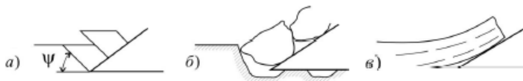
Рисунок 9 – Основные виды стружек (по В.П. Горячкину)
