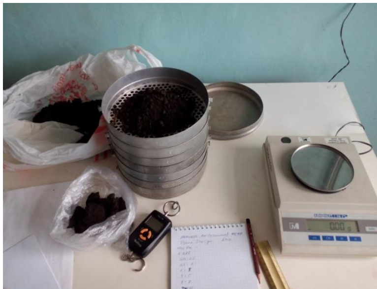
Рисунок 36 – Просеивание и взвешивание исследуемого материала
