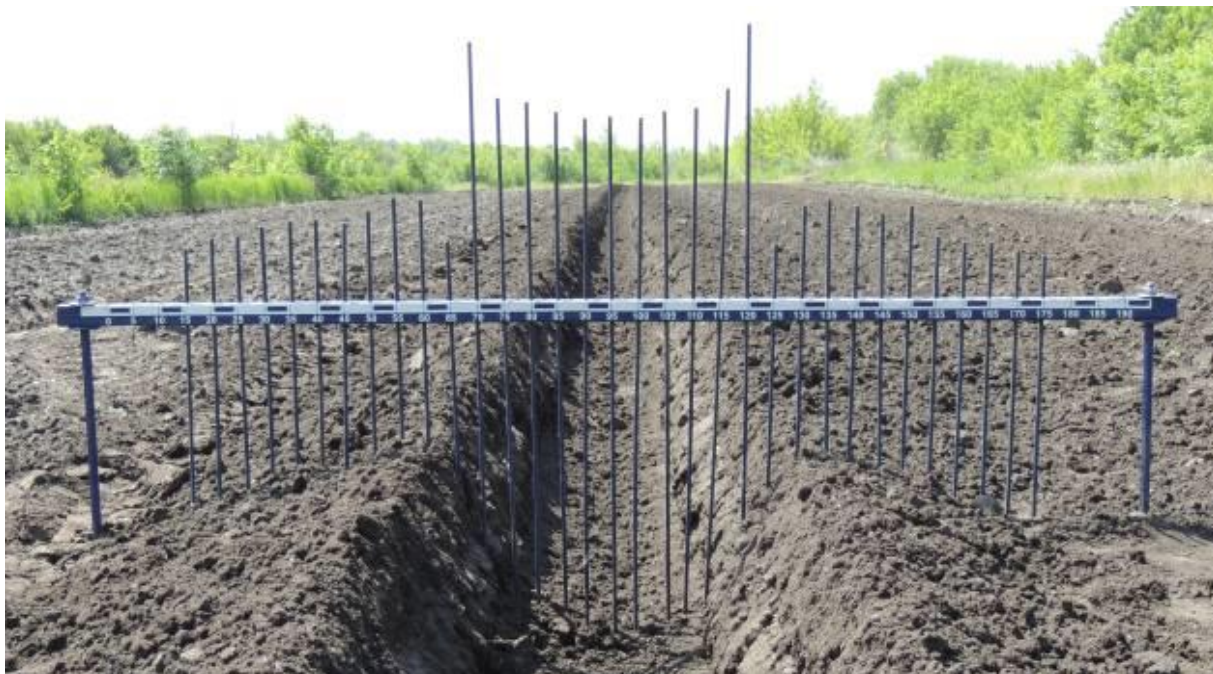
Рисунок 32 – Определение профиля нарезаемой борозды (установка профилометра)
