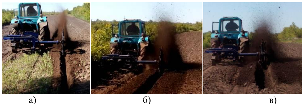
Рисунок 28 – Фрагменты испытаний универсального бороздонарезчика (а – узкая борозда ( \alpha=90^0 ), б – средняя борозда ( \alpha=85^0 ), в – широкая борозда ( \alpha=80^0 ))
