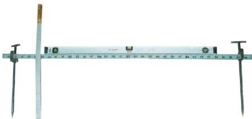
Рисунок 31 – Устройство для поперечного и продольного профилирования
