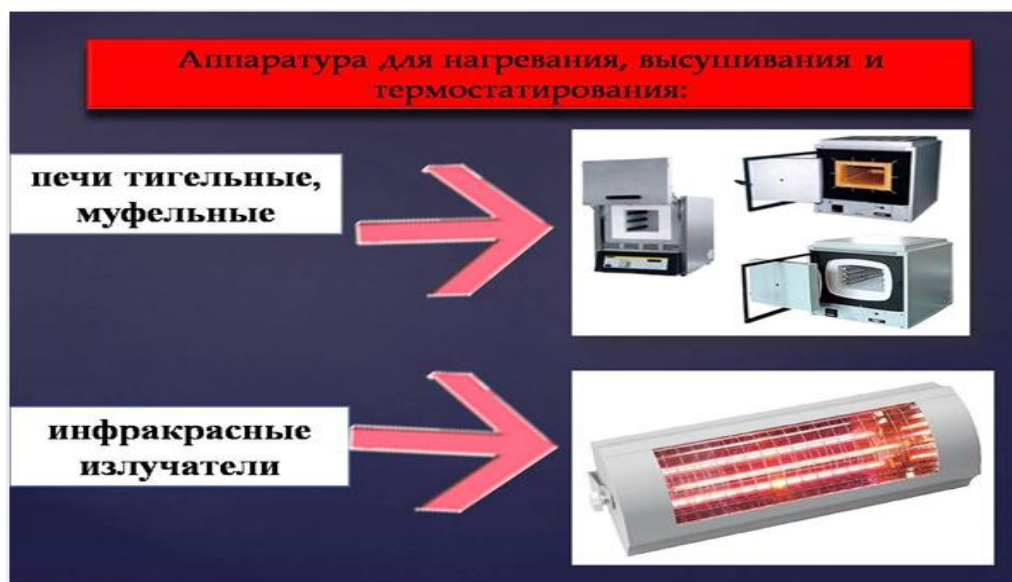
Рисунок 3.2 Аппаратура для нагрева, высушивания и термостатирования
