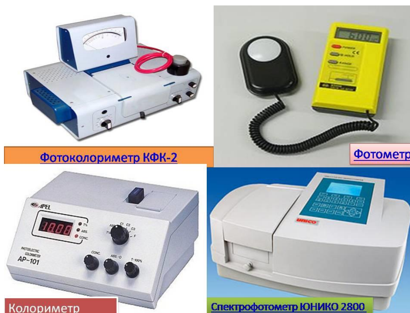
Рисунок 3.9 Измерительные приборы общетехнического назначения для биохимических исследований
