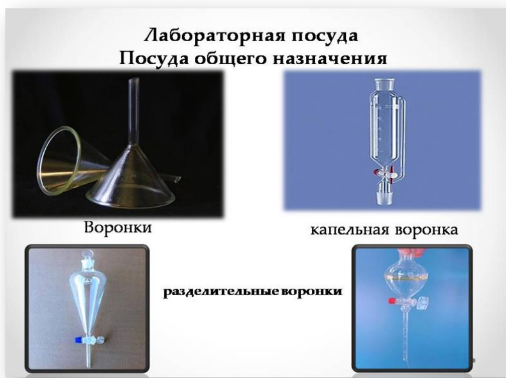
Рисунок 2.1 Посуда общего назначения (воронки)
