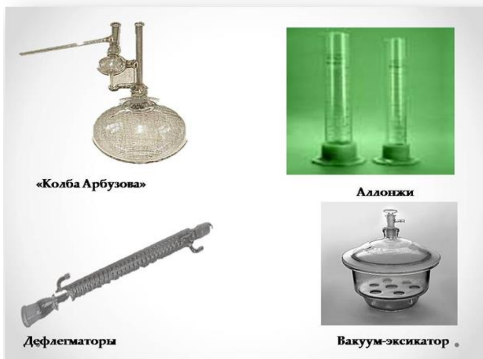
Рисунок 2.5 Колбы, дефлегматоры, аллонжи, вакуум-эксикатор
