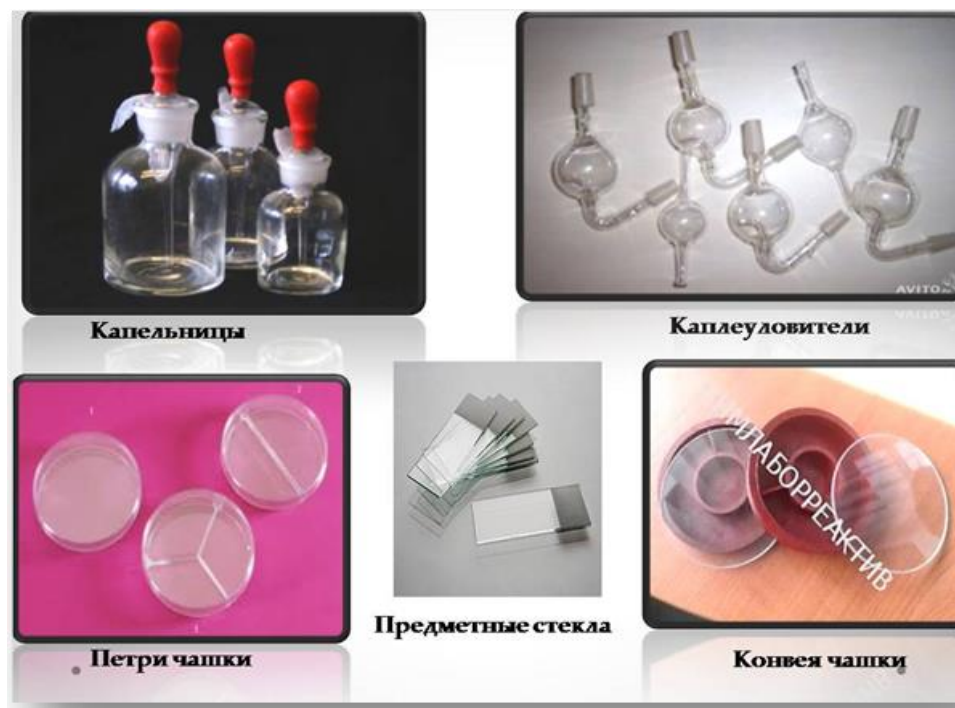
Рисунок 2.7 Капельницы, каплеуловители, Петри чашки, предметные стекла, Конвей чашки
