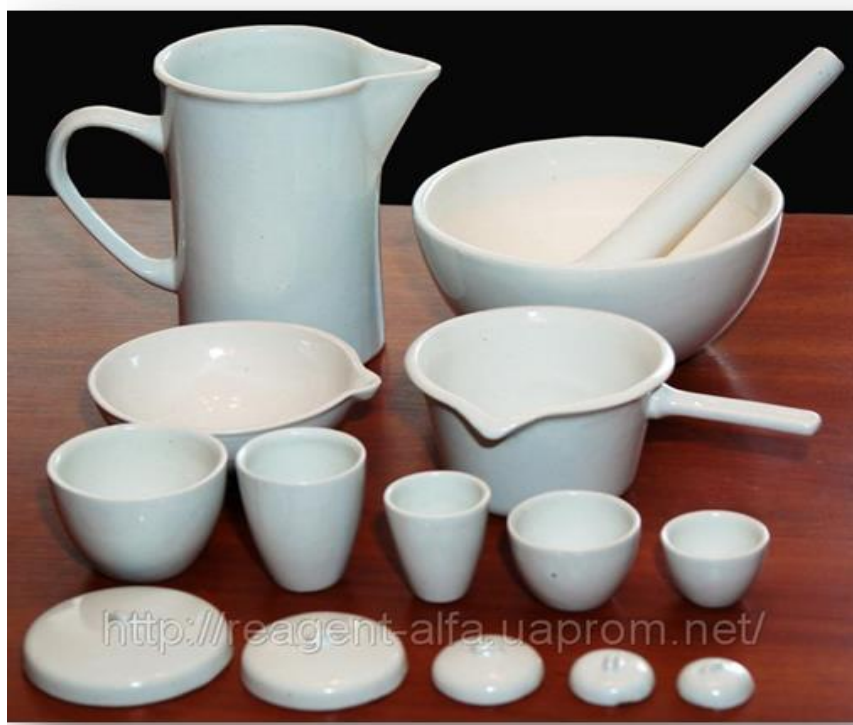
Рисунок 2.9 Фарфоровая и высокоогнеупорная посуда
