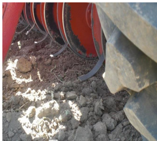
Сурет 66 – СЗ-3,6 дән сепкішінің жетілдірілген сіңіргіштері
