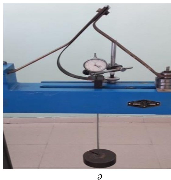
Сурет 53 – Қысқыш пластинасының қаттылығын анықтау арналған:
