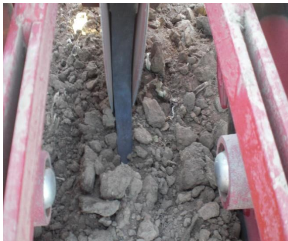
Сурет 66 – СЗ-3,6 дән сепкішінің жетілдірілген сіңіргіштері
