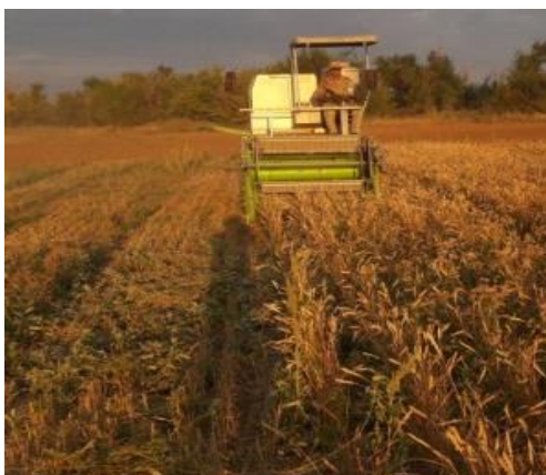
Сурет 76 – «WINTERSTEIGER» габариті шағын селекциялық комбайнымен тәжірибелі телімдегі егінді өру және бастыру
