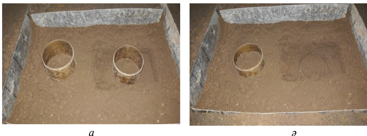
Сурет 64 – Кескіш цилиндрлер:
