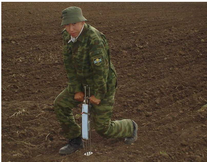
Сурет 70 – А. Н. Ревякиннің қаттылық өлшегішімен топырақтың қаттылығын анықтау
