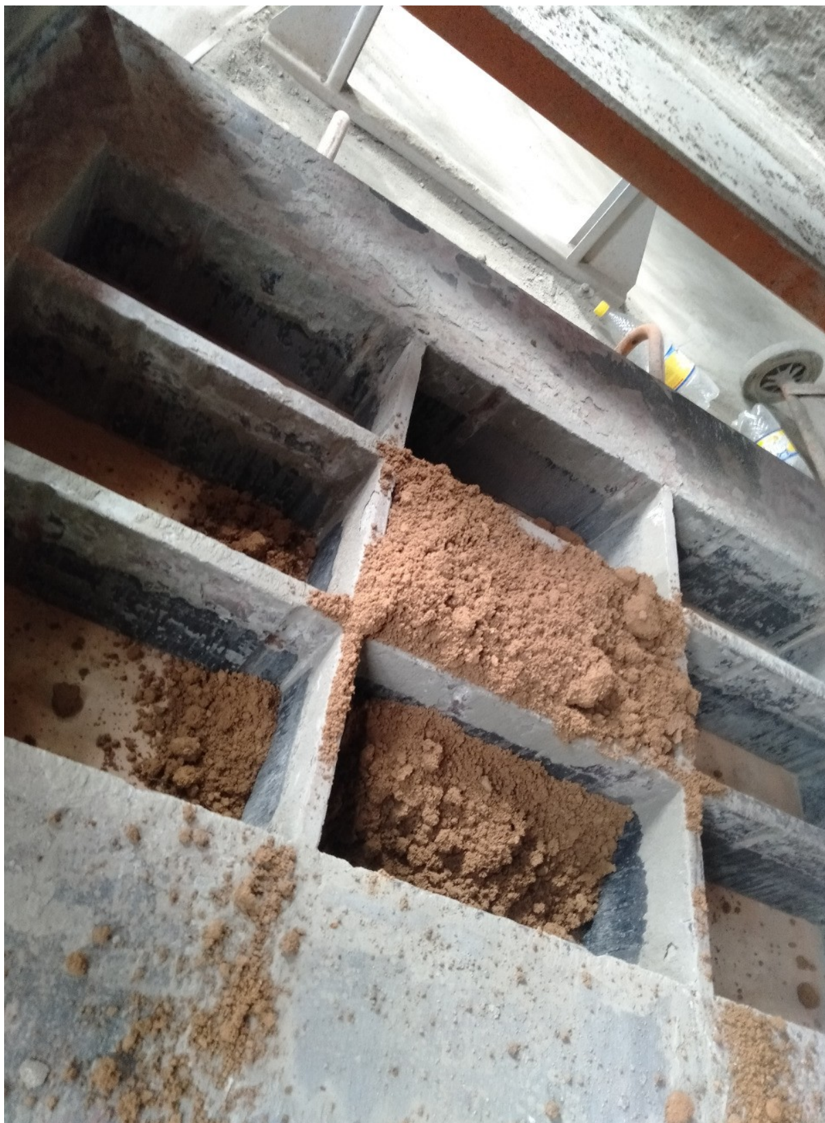
Рисунок 8 – Загрузка сырьевой смеси в формы мобильной установки «Мастек Метеор» для вибропрессования керамических брусчаток
