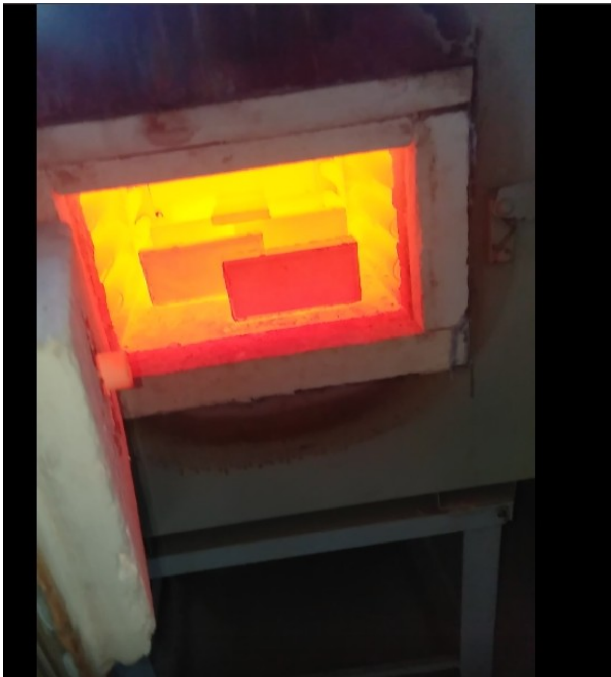
Рисунок 4 – Процесс обжига отформованных кермических брусчаток в электрической муфельной печи
