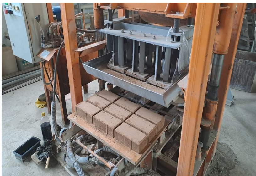
Рисунок 32 - Общий вид отформованных сырцовых керамических брусчаток на формовочном комплексе «Мастек-Метеор»
