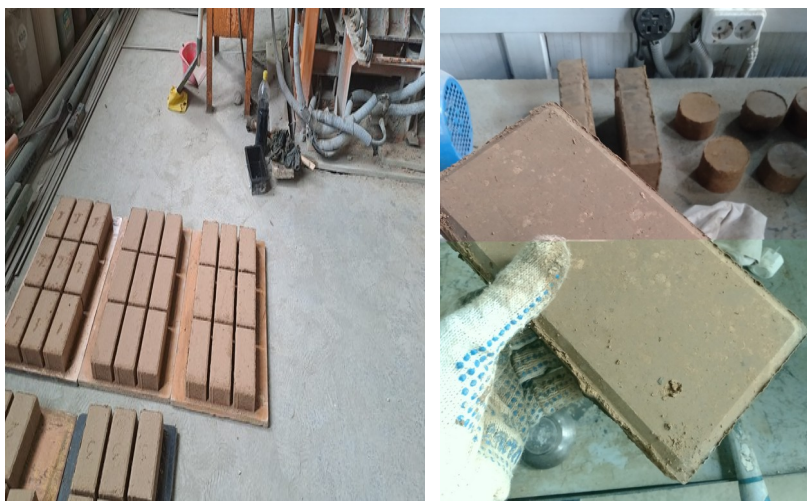
Рисунок 37 - Отформованные образцы методом вибропрессования сырьевые керамические брусчатки
