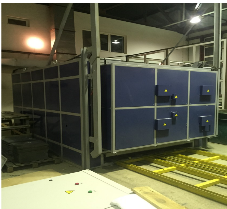
Рисунок 38- Камерная печь марки с выдвижным подом
