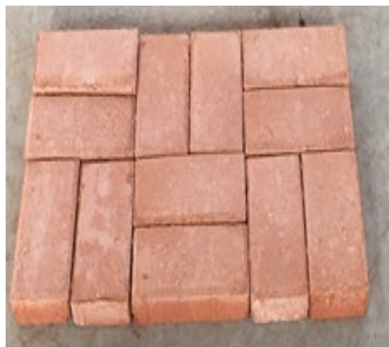
Рисунок 39 - Общий вид обожженных керамических брусчаток отформованных вибропрессованием
