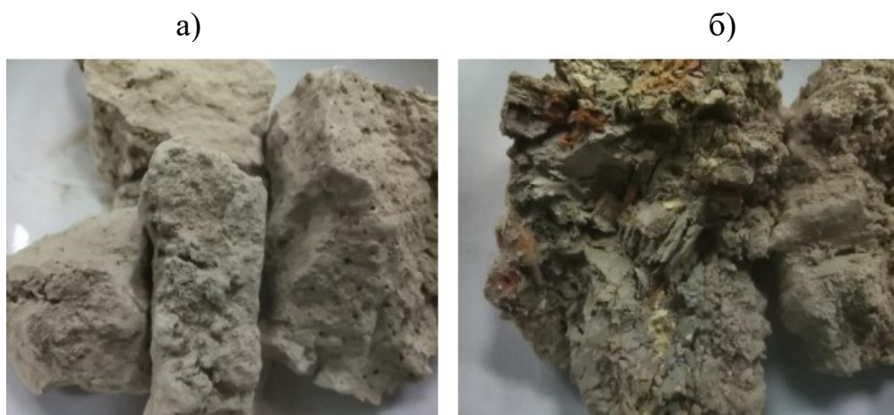
Рисунок -1 Внешний вид исследуемых сырьевых материалов а – суглинок, б – бентонитовая глина
