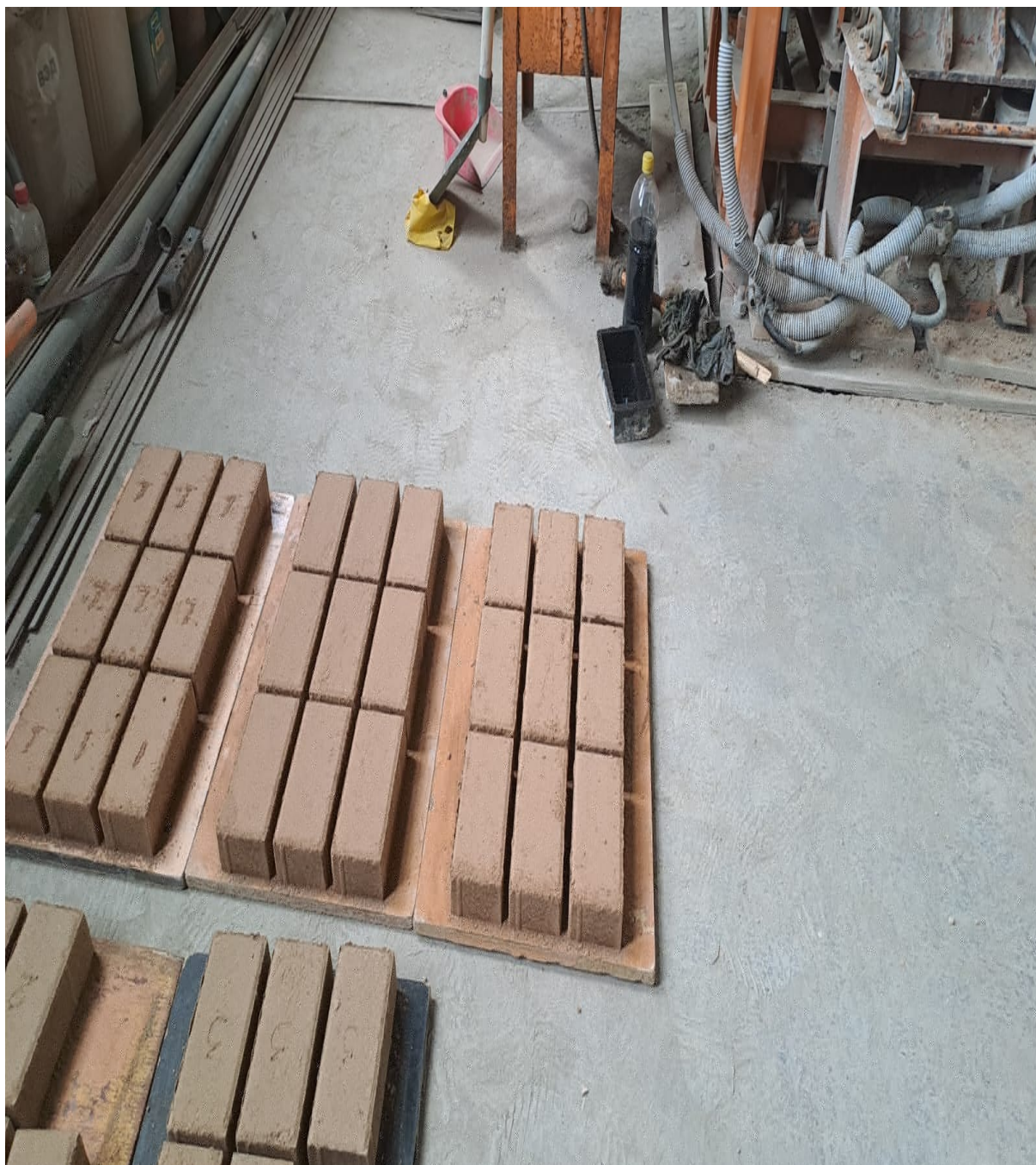
Рисунок 3 - Отформованные сырцы керамических брусчаток методом вибропрессования
