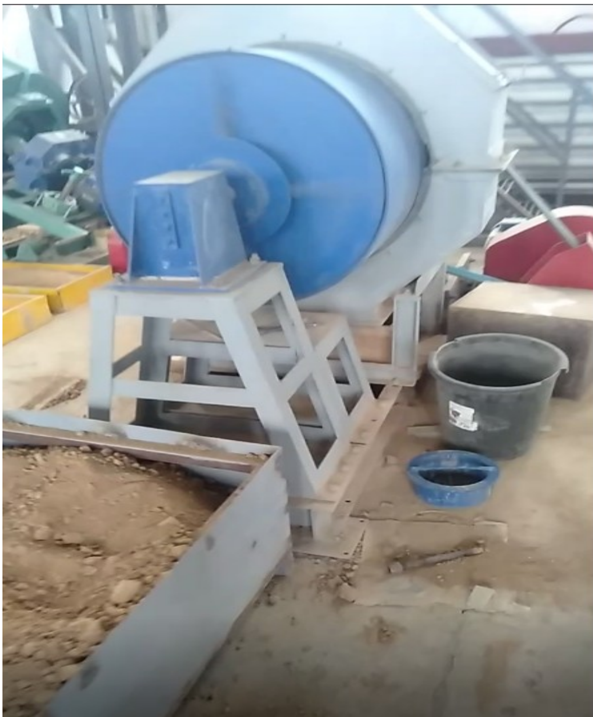
Рисунок 2 - Шаровая мельница с емкостью 300 килограмм для тонкого помола глинистых компонентов
