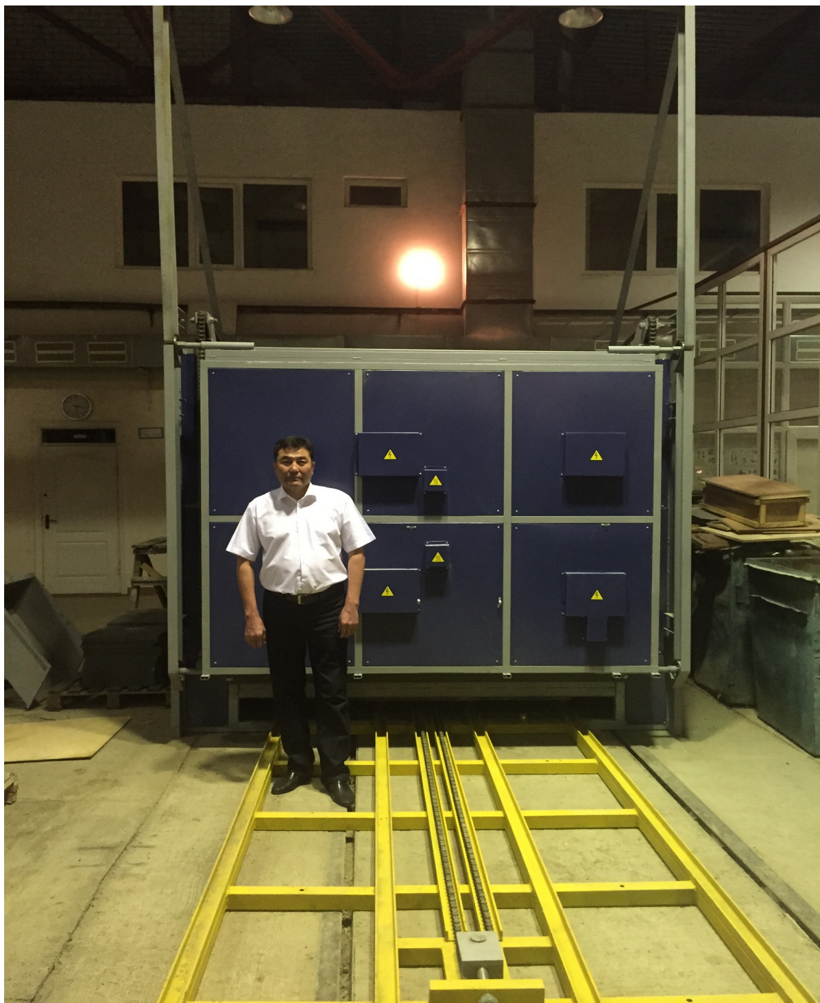
Рисунок 5 – Промышленная камерная печь с выдвижным подом для обжига опытно-промышленной партии керамических брусчаток
