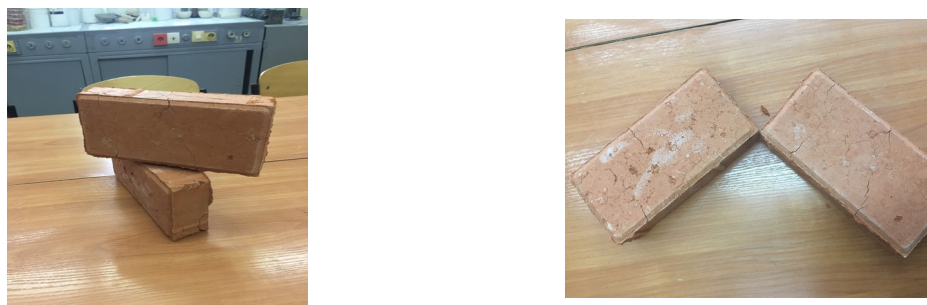
Рисунок 26 - Образцы керамических брусчаток на основе сырьевой композиции глина – тальковая порода
