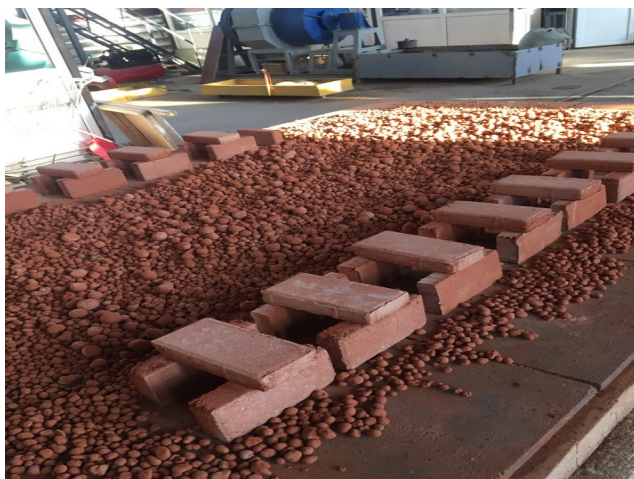
Рисунок 39 - Общий вид обожженных керамических брусчаток отформованных вибропрессованием
