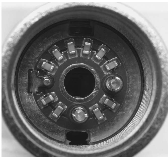
Рисунок 2.48 - Разъем XLR с 10 SMT-конденсаторами между экраном кабеля и задней крышкой разъема
