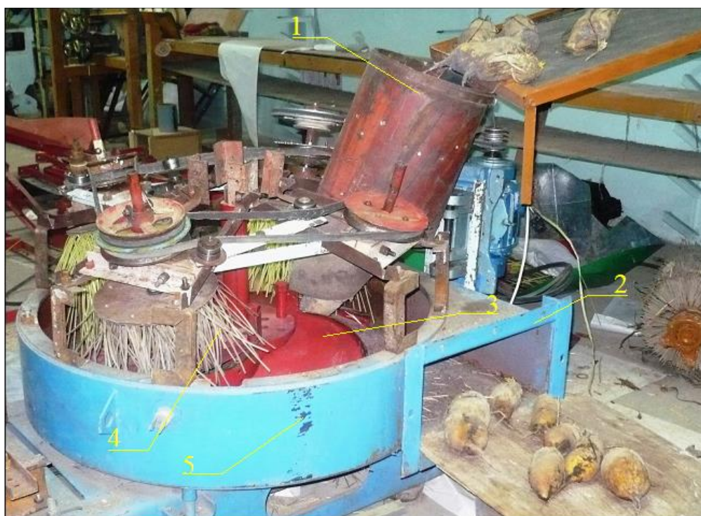
Рисунок 3.2 – Экспериментальный образец устройства для очистки корнеклубнеплодов от загрязнений: 1– загрузочный бункер, 2– выгрузной лоток, 3– горизонтальный диск с криволинейной крыльчаткой, 4– роторная щетка, 5– корпус установки.
