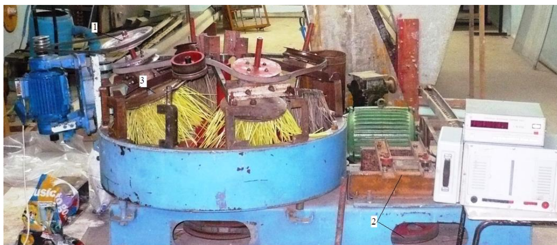
Рисунок 3.3 – Изменение конструктивно-режимных параметров на экспериментальном образце очистительного устройства: 1 – частота вращения щетки n_{щ} ; 2 – частота вращения диска n_d ; 3 – угол наклона щеток \psi'
