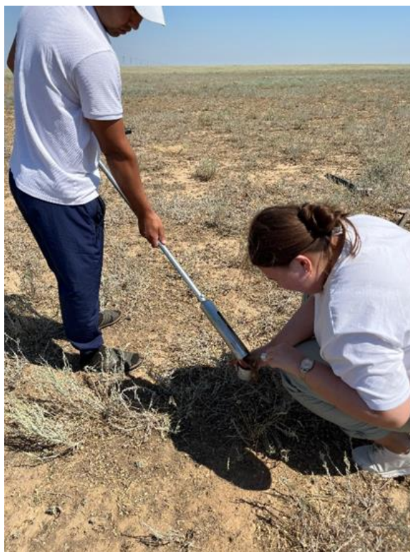
Рисунок 26 – Отбор проб почвы для определения влажности почвы пастбищ
