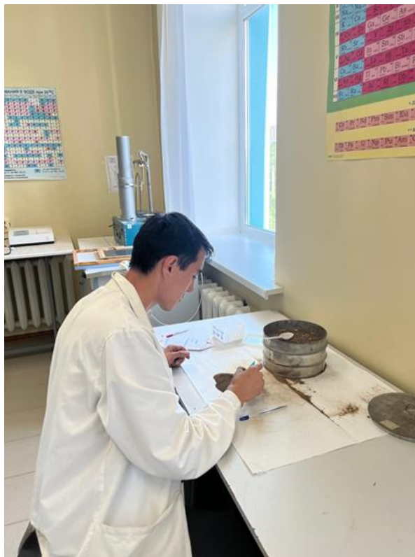
Рисунок 29 – Определение структуры почвы пастбищ методом сухого отсева
