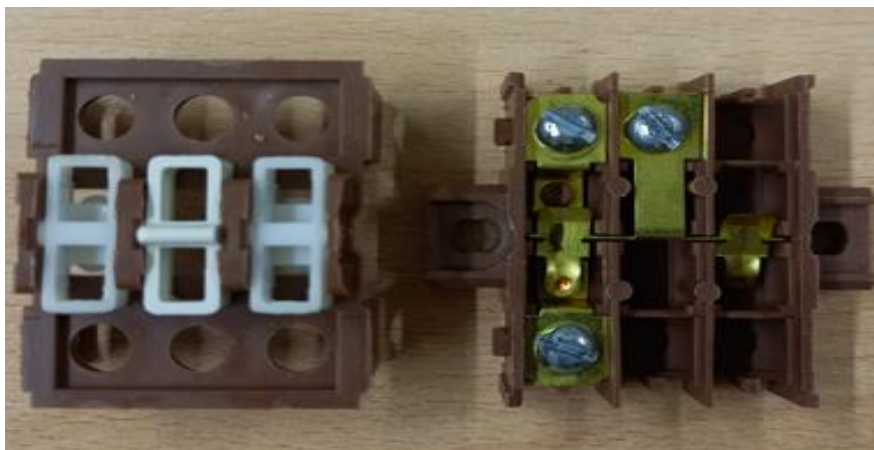
Сурет 4 – Қарапайым екі батырмалы ажыратқыш түйіспесін өтпелі ажыратқышқа айналған түрі
