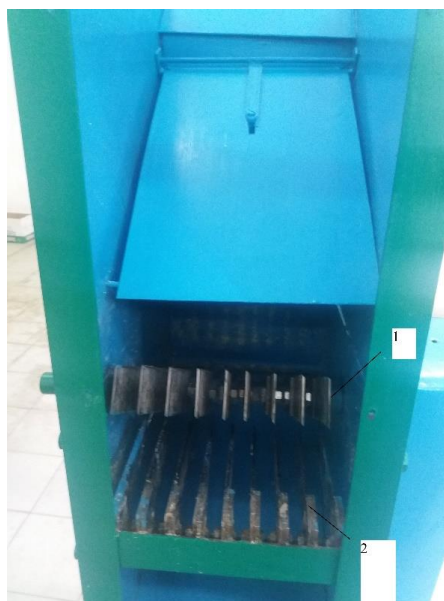
Рисунок 2 – Рабочие органы измельчителя корнеплодов: 1- ножи; 2 – противорезы.
