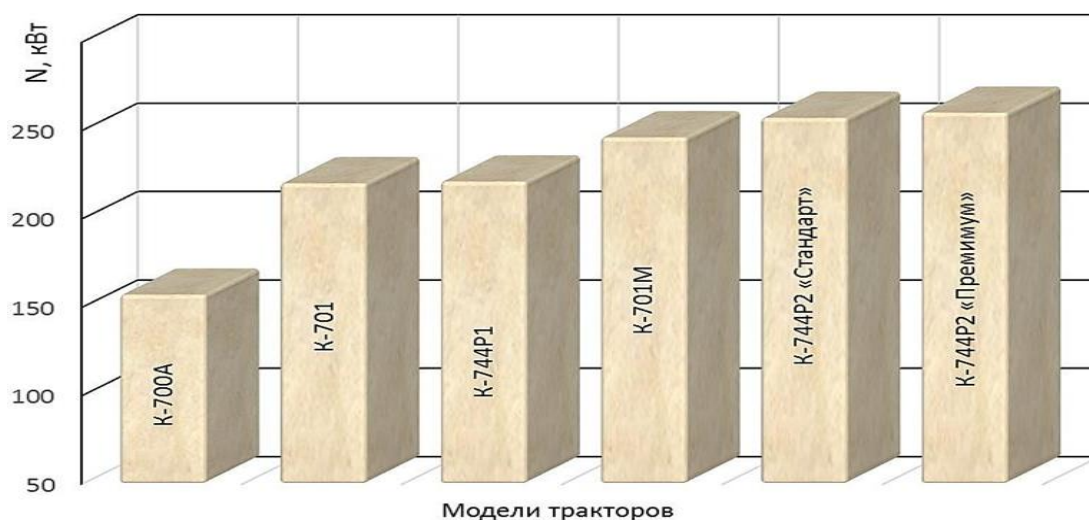
Сурет 6 – К-700 және К-744 сериялы ресейлік тракторлар модельдерінің диаграммасы
