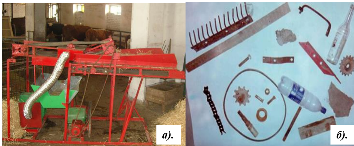
Рисунок 6 – а). Производственные испытания сепарирующего устройства; б). Инеродные тела
