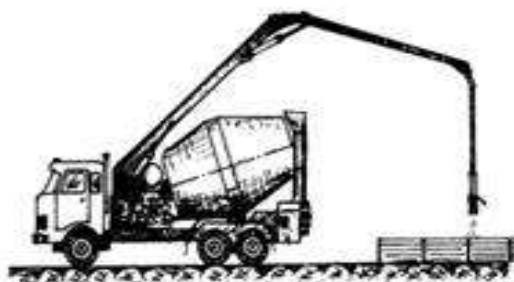
Рисунок 3 - Автобетононасос с бетоносмесителем
