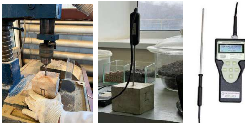
Сурет 1 - Үлгінің жылу өткізгіштігін анықтау
