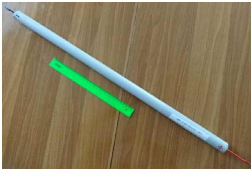
Сурет 4 - Li-Ion типті тұрбалы аккумуляторлы батареясы
