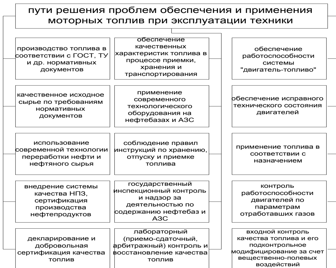
Рисунок 1 - Классификация путей решения проблем обеспечения и применения топлив используемых при эксплуатации транспортной техники
