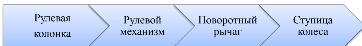
Сурет 5 - Рульдік басқару элементтерінің реттілігі
