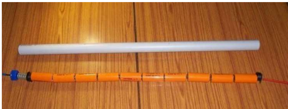
Сурет 3 – Тізбектей жалғанған шықпалары бар 10 батарея тобы
