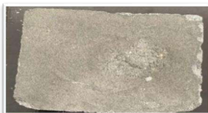
Сурет 3 – 40x50x10 қалыпта құйылған бор-гипс-күл қоспасының үлгісі
