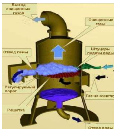
Рисунок 4 - Пенный скруббер.
