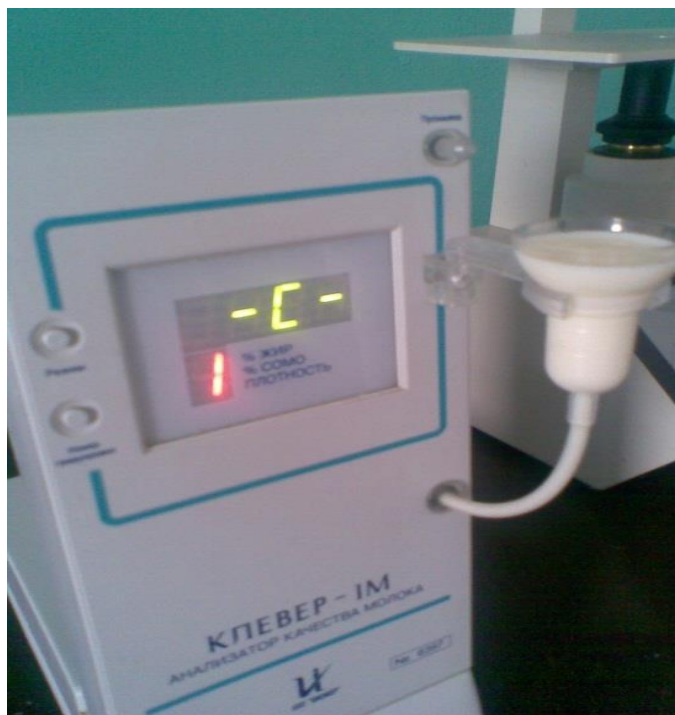
Сурет 1 – Қой сүттің сапасын «Клевер 1М» құрылғысымен анықтау
