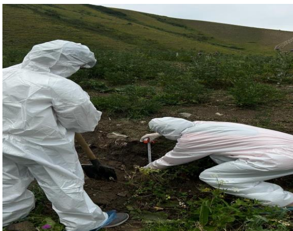
Сурет 1 – 0-ден 20 см-ге дейінгі әртүрлі тереңдікте топырақтан сынама алу барысы
