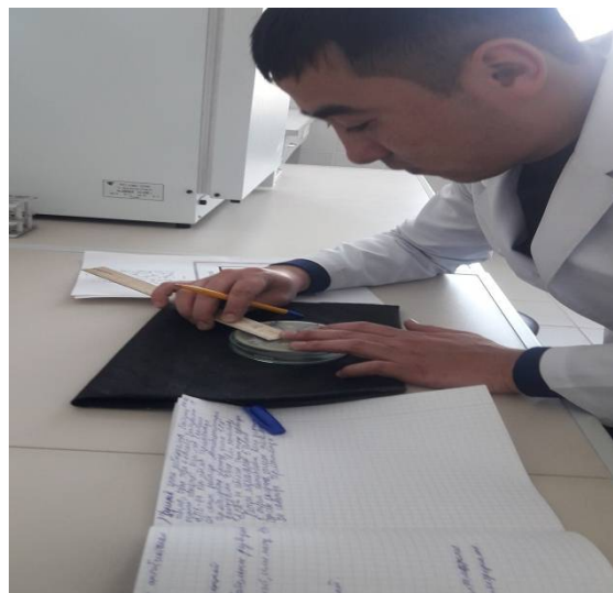
Рисунок 4,5 - Определение чувствительности к антибиотикам (диско-диффузионный метод)
