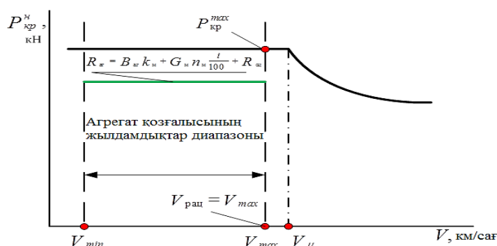
Сурет 7.13 – График арқылы V_\mu \geq V_{max} болғанда V_{рац} шамасы
