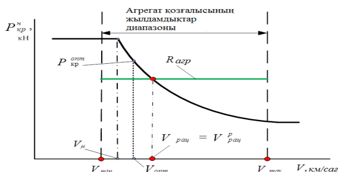
Сурет 7.14 – График арқылы V_{min} \leq V_{opt} \leq V_{max} және V_{рац}^p \leq V_{max} болғанда V_{рац} жылдамдығын анықтау
