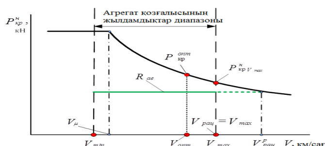
Сурет – 7.15. График арқылы V_{\min} \leq V_{\text{опт}} \leq V_{\max} және V_{\text{рац}}^p \geq V_{\max} болғанда V_{\text{рац}} жылдамдығы мәнін анықтау
