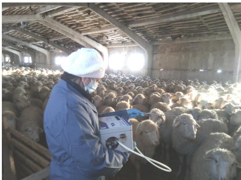
Рисунок 1 – Измерение газового состава газоанализатором ГАНК-4 КПКУ 413322 002
