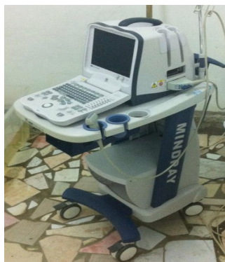
3.9 – сурет. Бекіре тұқымдас балықтардың аналықтарында гонаданың жынысқа жетілу сатысын анықтайтын УДЗ аппараты
