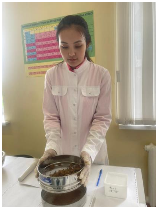
Сурет 4 – Құрғақтай елеу арқылы топырақ құрылымын анықтау
