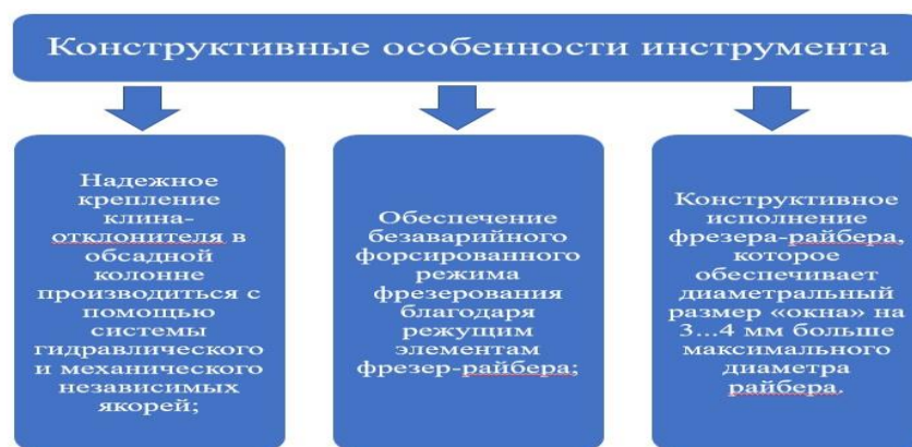
Рисунок 6 – Конструктивные особенности инструмента
