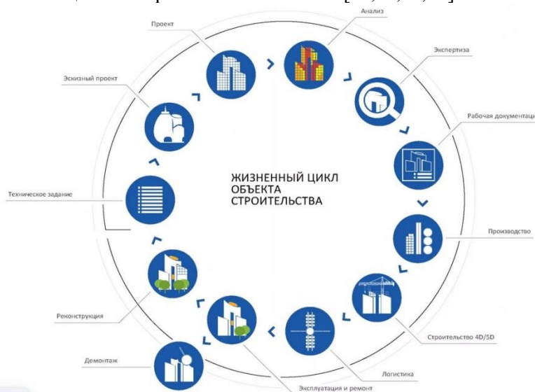
Рисунок 1 – Концепция системы управления жизненным циклом строительного объекта
