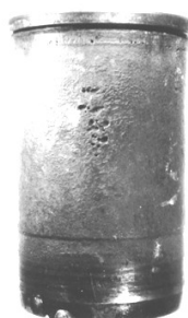
Рисунок 2 – Кавитационные разрушения стенки гильзы двигатель КамАЗ-740
