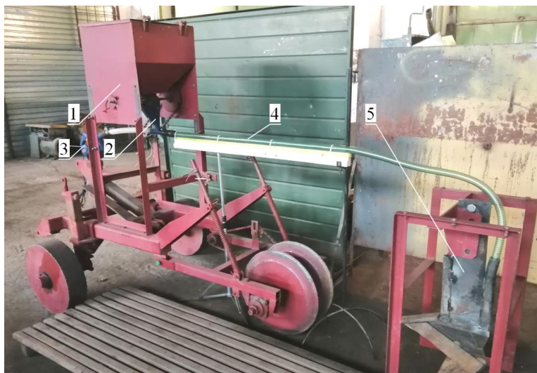
1 – бункер с удобрениями; 2 – дозатор удобрений; 3 – вентиляторная установка; 4 – тукопровод; 5 – плоскорежущий рабочий орган
