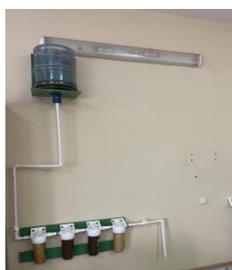
Рисунок 6 – Разработанная экспериментальная модульная лабораторная установка для опреснения и очистки воды с использованием модифицированных сорбентов на основе кремнистой породы - опоки
