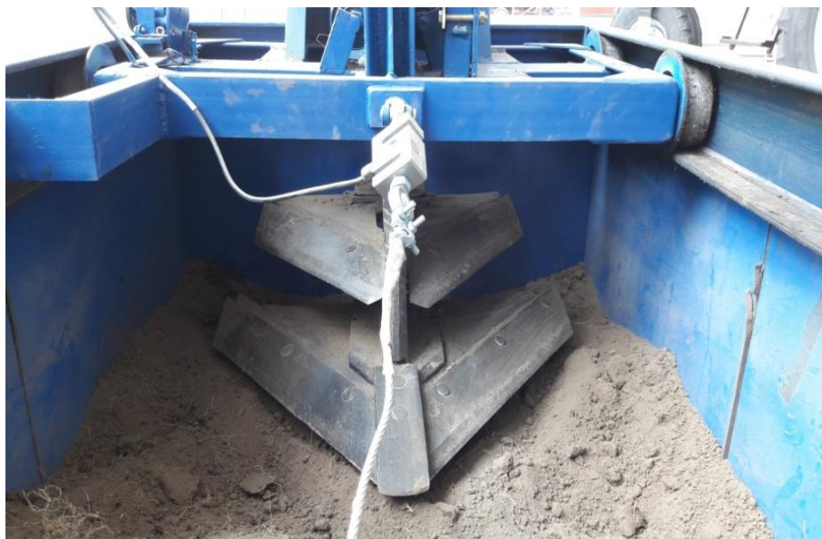
Сурет 4 – Топырақ арнасындағы эксперименттік жұмыс органы
