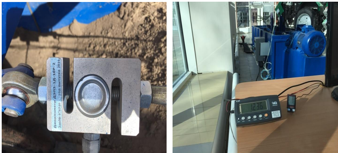
Сурет 5 – DEP3-1D-10R-2 электронды динамометрі және R320 контроллері
