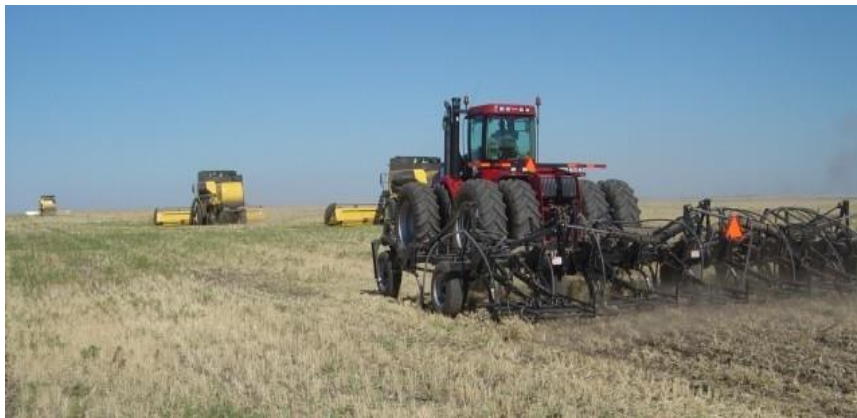
Рисунок 1 – Поверхностная обработка почвы посевным комплексом «ФлексиКоил» вслед за комбайнами
