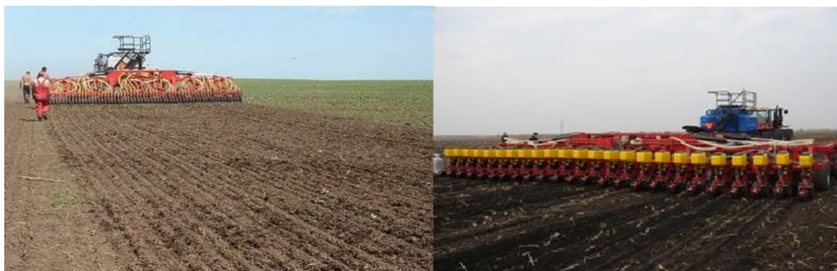
Рисунок 2 – Посевной комплекс «Терминатор» с высеваящими сошниками для зерновых культур (слева) и пропашных культур (справа)
