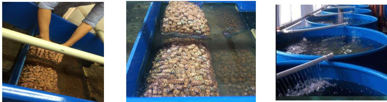
Рисунок 3. Процесс замены импортных наполнителей на органоминеральный керамический биоматериал собственного производства для биофильтраций и очистки воды бассейна действующего опытно-производственного участка «Аквакультуры» ЗКАТУ им. Жангир хана по выращиванию мальков осетровых рыб в условиях замкнутого водообеспечения.
