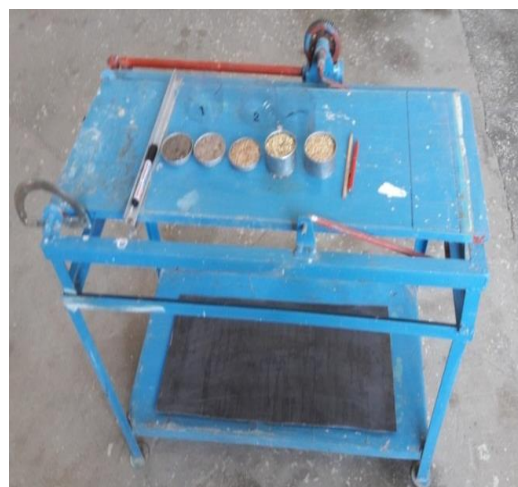
Рисунок 1 – Общий вид лабораторной установки «Наклонная плоскость»
