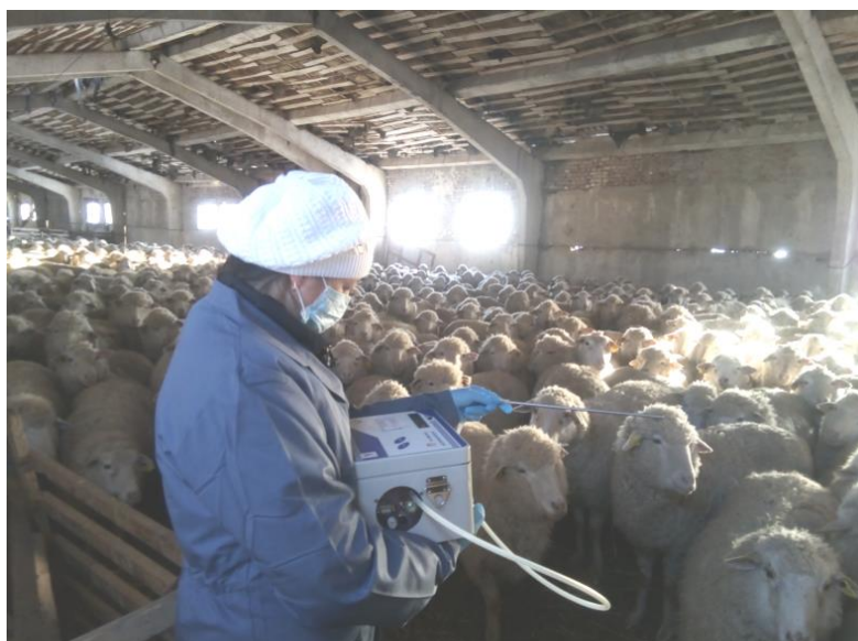
Рисунок 1 – Измерение газового состава газоанализатором ГАНК-4 КПУ 413322 002
