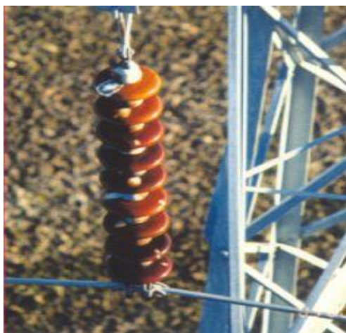
Сурет 2 – Оқшаулағыш юбканы доғаның көмегімен бұзу
