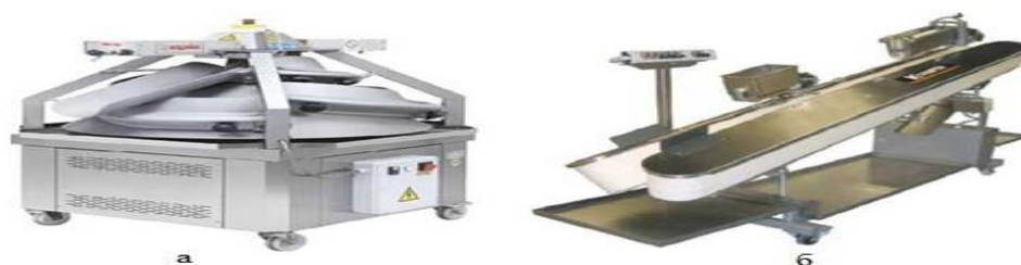
Рисунок 1 – Округлители: а – конусный, б – ленточный
