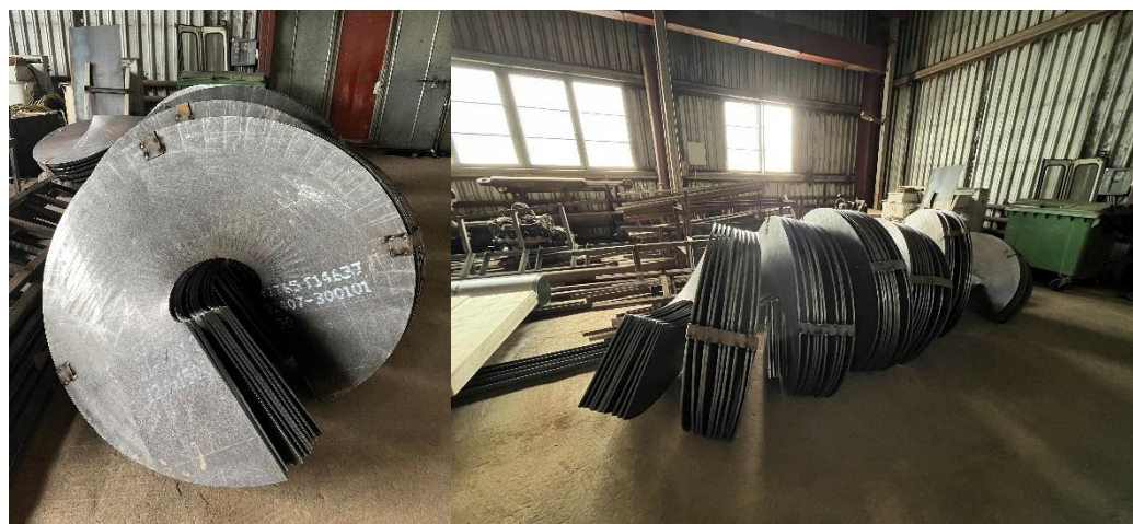
Рисунок 2 – Лепестки (витки) шнеков, изготовленные силами ООО СМУ-2 «Эколог-БСНС»
