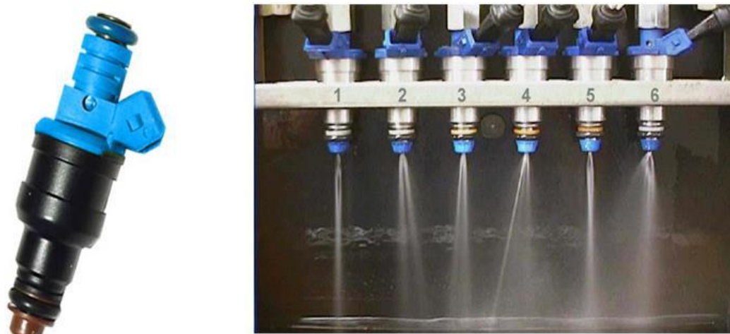
Рисунок 3 – Электроуправляемая форсунка для впрыска жидких рабочих растворов, их тарировка и стендовая проверка.
