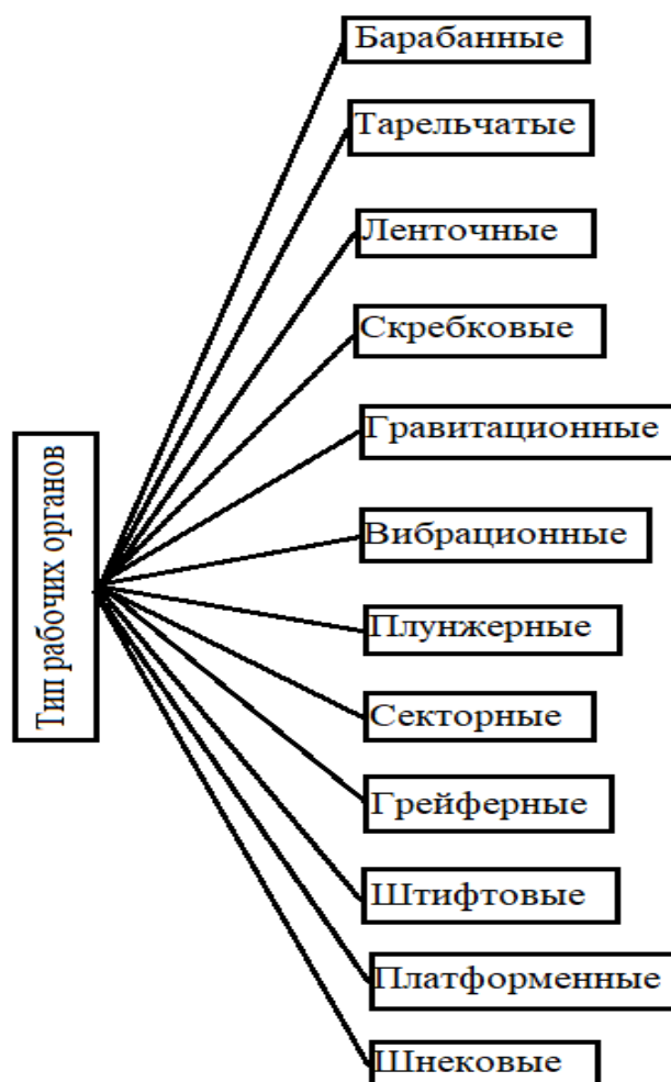
Рисунок 6 - Классификация дозирующих устройств по типу рабочих органов
