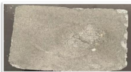
Сурет 3 – 40x50x10 қалыпта құйылған бор-гипс-күл қоспасының үлгісі
