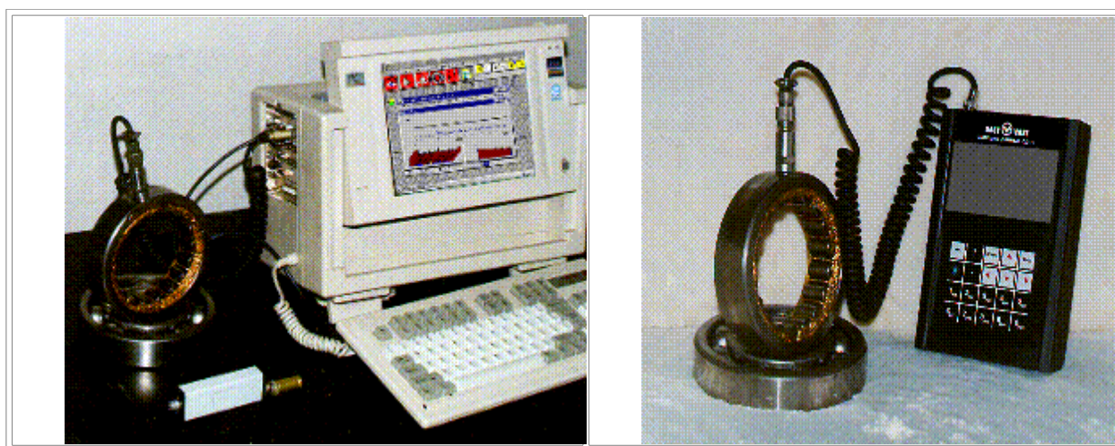
Рисунок 1 – Стационарная и переносная системы вибрационного мониторинга и диагностики машин и оборудования
