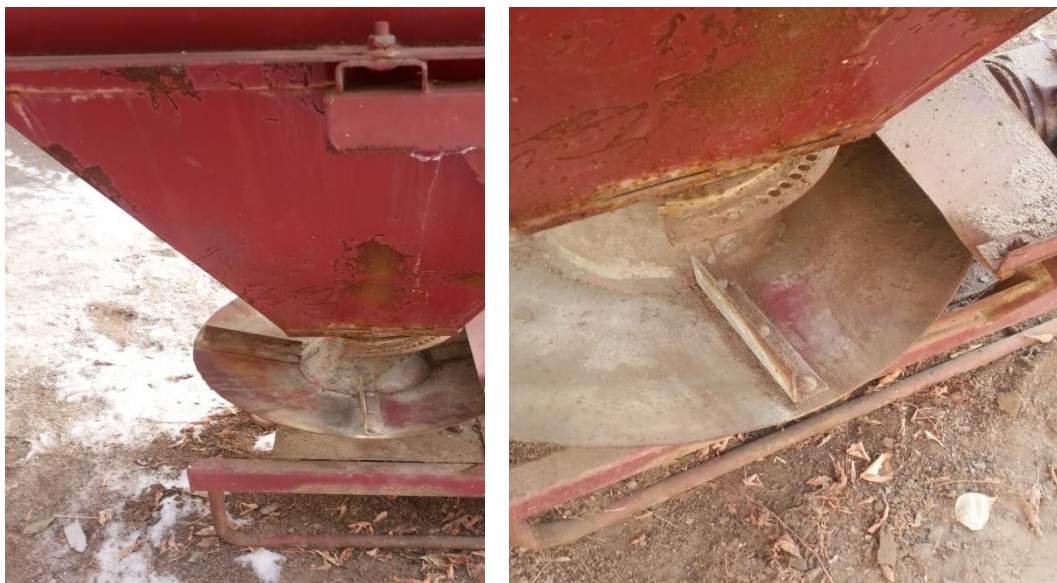
Сурет 1. Минералды тыңайтқыштарды шашқыштардың коррозиялық тозуы
