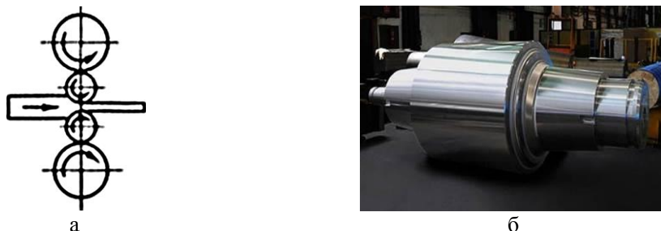
Рисунок 1. Оборудование клетки стана холодной прокатки: схема квартостана (а) и вид опорного валка (б)
