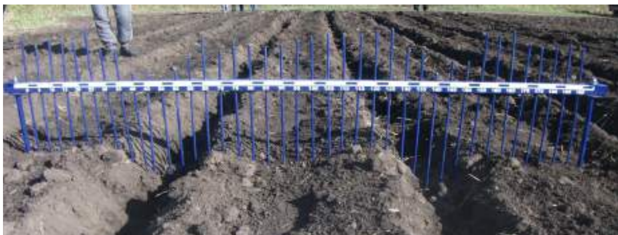
Рисунок 3- Определение микрорельефа створа профилометра.
