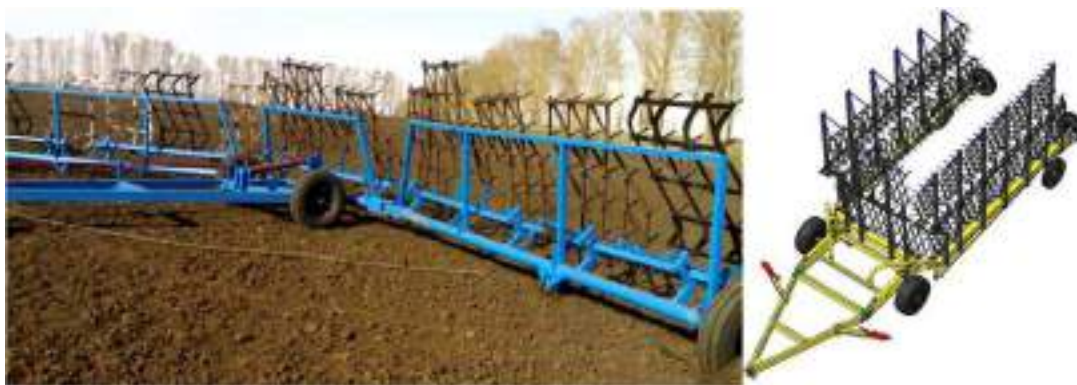
Рисунок 1 – Зубовые бороны на гидрофицированной сцепке
