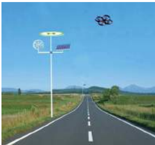
Рисунок 3 – Наземная зарядная станция с ветро-солнечной системой электропитания
