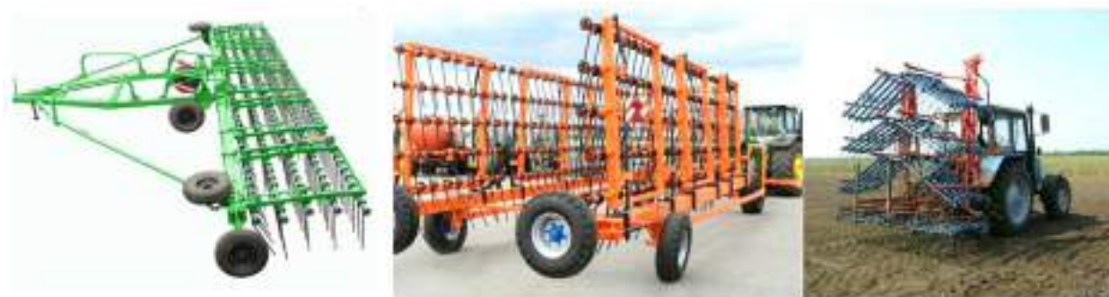
Рисунок 2 – Пружинные бороны в рабочем и транспортном положении
