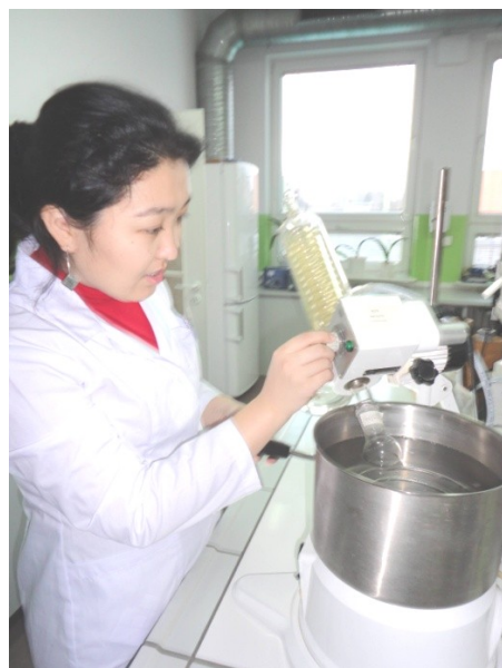
2 – сурет. Балық етінде хроматографпен пестицидтерді анықтау үшін сынама дайындау үстінде
