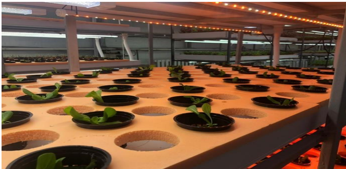
Рисунок 1 – Экспериментальные установки для выращивания листового салата
