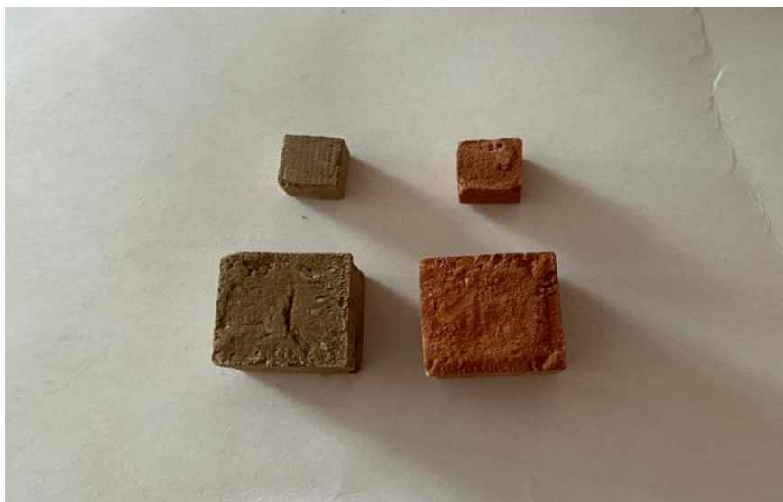
Сурет 4 – Фракциялары әр түрлі, кептірілген мен күйдірілген үлгілер
