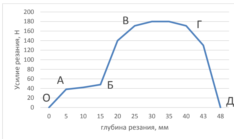
Рисунок 4 – Усилие резания корнеклубнеплода
