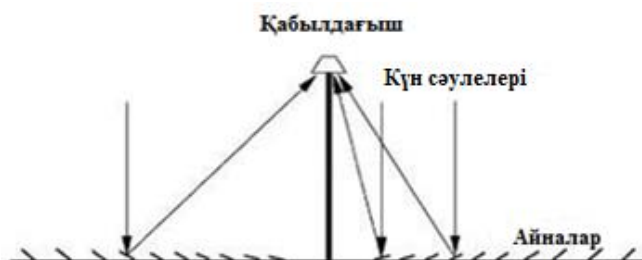
Сурет 2 – Френель айналары бар жалпақ айна шағылыстырғышы
