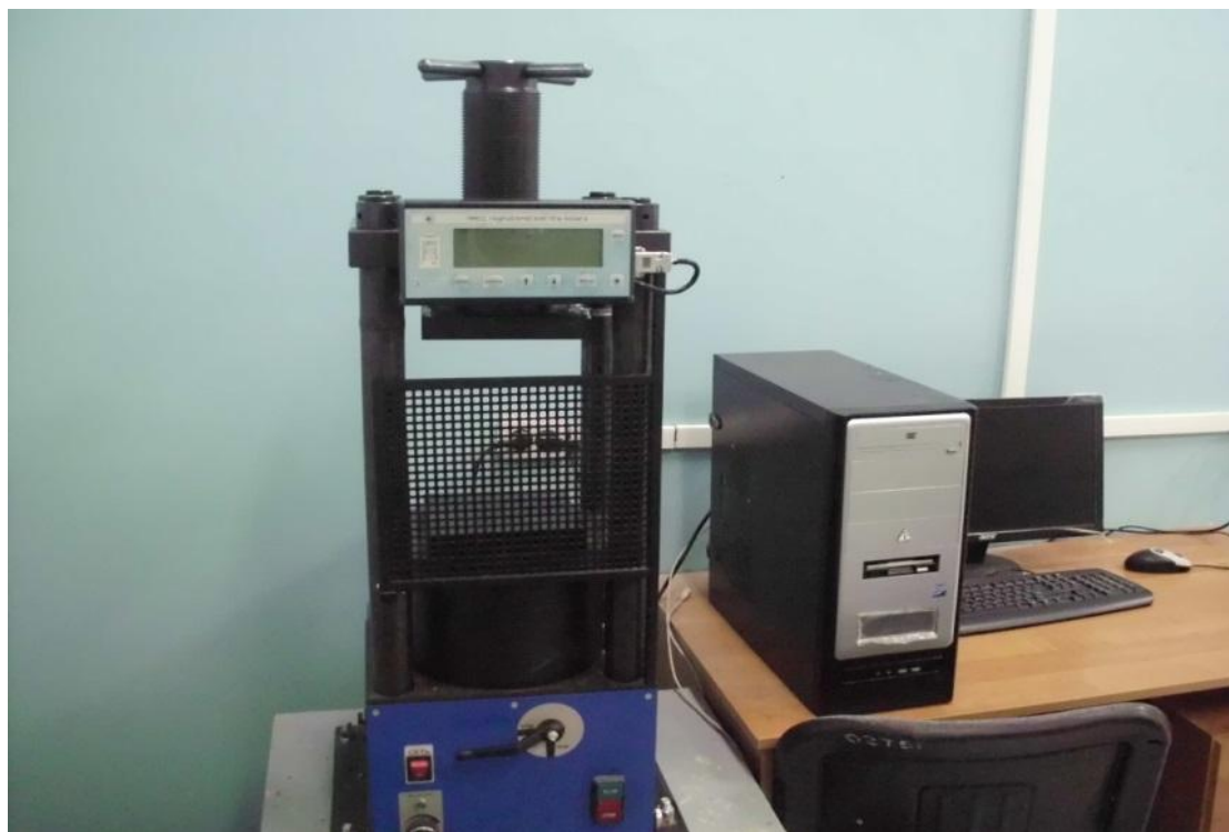
Сурет 3 – Бетон үлгілерінің сығу кезіндегі беріктігін анықтауға арналған гидравликалық пресс Азгабаритті ПГМ – 500 МГ4
