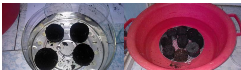
Сурет 2 – Брикет үлгілері. Үлгілерді су сіңіргіштігін анықтау
