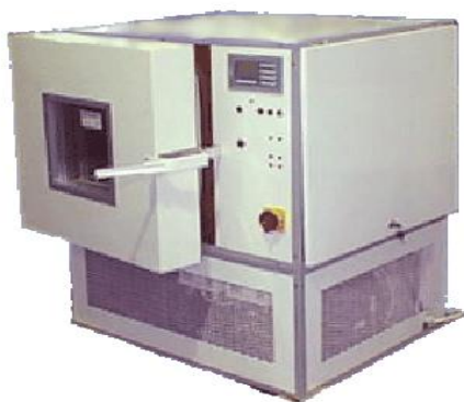
Сурет 1 – Бетонның аязға тұрақтылығын анықтау үшін қату процесіне арналған мұздатқыш камера (ШСП-0,5-70)
