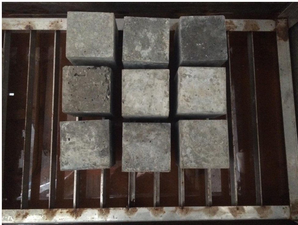
Сурет 2 – Бетон үлгілерін сумен қанықтыру
