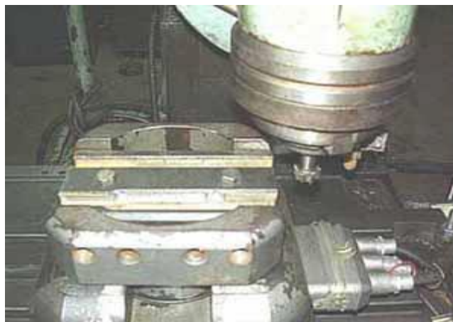
Рисунок 2 - Внешний вид динамометра 9257Вс, закрепленным столиком и заготовкой
