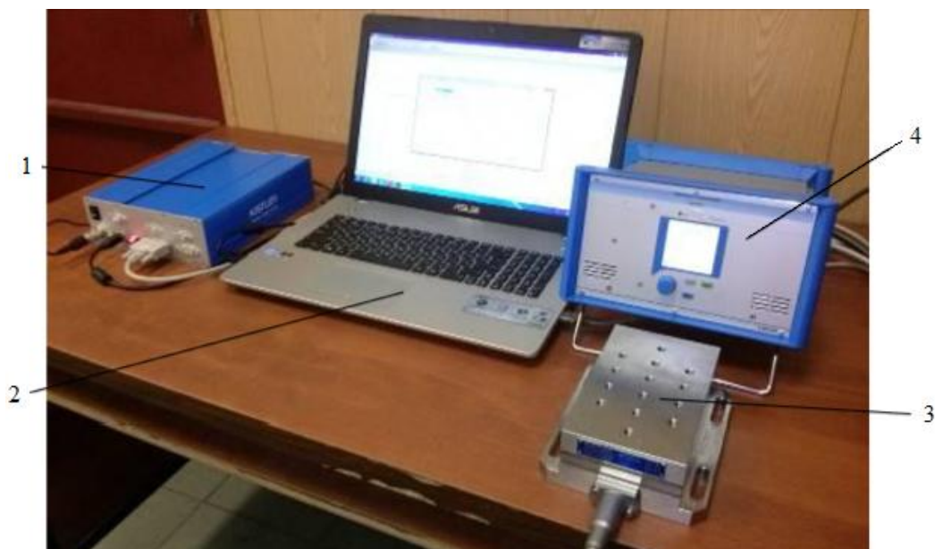
Рисунок 1 - Состав установки на базе динамометра 9257В: 1 - блок АЦП 5697; 2 – ноутбук с установленным программным обеспечением DynoWare; 3 – динамометр 9257В; 4 - зарядовый преобразователь 5070А10100, содержащий 4-х канальный усилитель.
