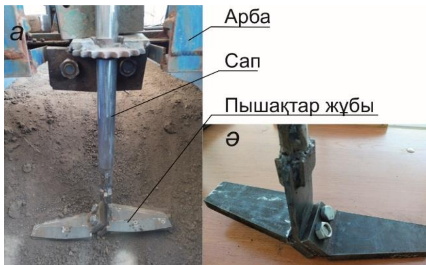
Сурет 1 – Кесу жиегінің бұрышы 27^\circ пышақтар жинақталған арба (а), кескіш жиек жасалмаған пышақ (ә)
