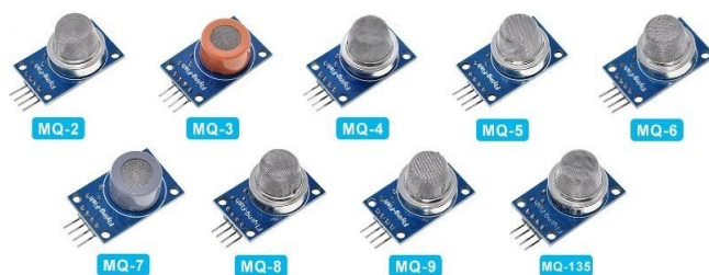
Сурет 1 – MQ сериялы газ датчиктері: MQ-2-пропан C 3 H 8 , метан CH 4 , Н-бутан C 4 H 10 ; MQ-3-жұп C 2 H 5 OH; MQ-4 - табиғи газ; MQ-5-метан CH 4 , пропан C 3 H 8 ; MQ-6-сұйытылған мұнай газы; MQ-7-көміртегі тотығы газ CO; MQ-8-H 2 ; MQ-9-көміртегі тотығы CO, метан CH 4 ; MQ-135-аммиак NH 3 , азот оксидтері NO x , көмірқышқыл газы CO 2 .
