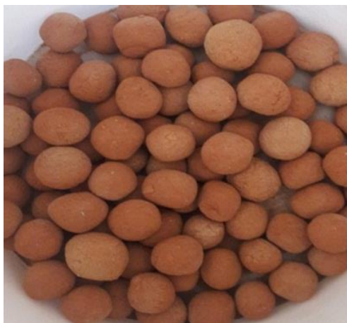
Рисунок 2. Структура керамдора после обжига
