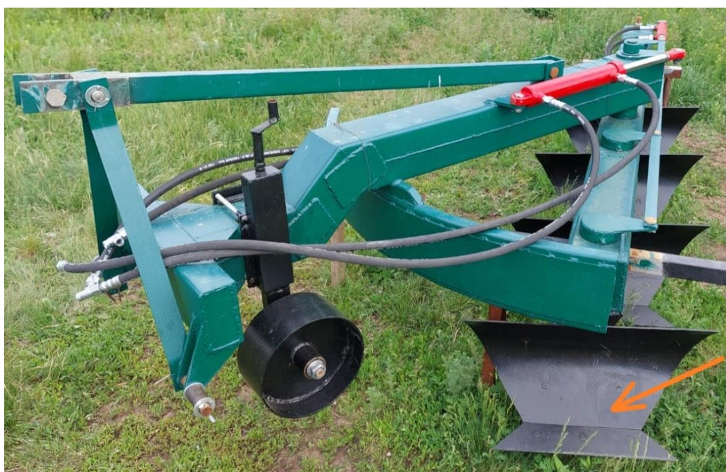
Сурет 4 - Ромб тәрізді жыртуға арналған соқаның корпусы
