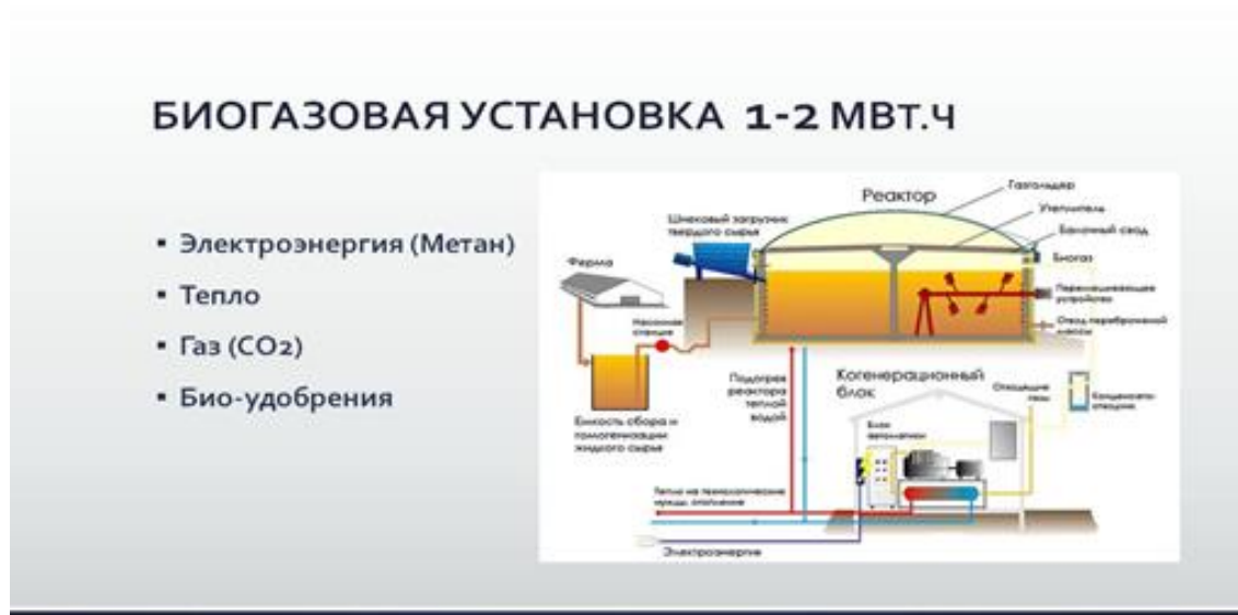
Сурет2 – Биогаз электр энергиясын немесе салқындатқышты алу үшін қолданылатын құрылғы
