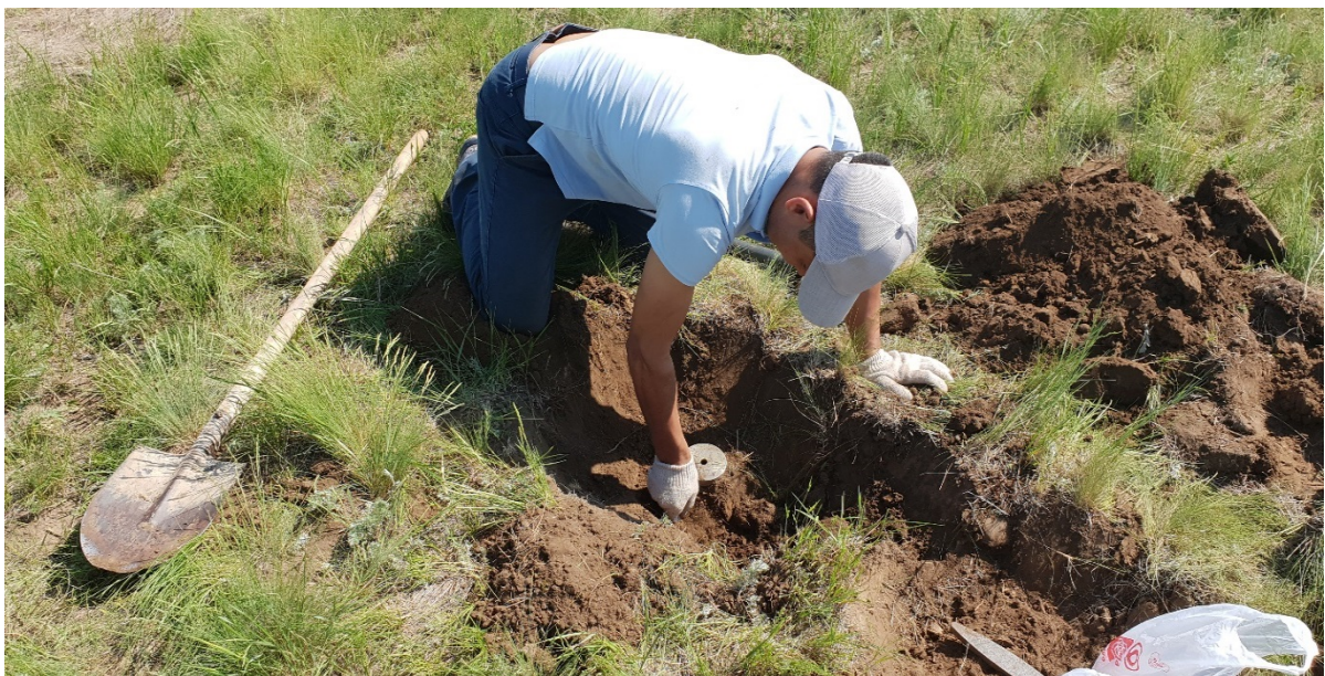
Определение плотности почвы пастбищ кх «Есет»
