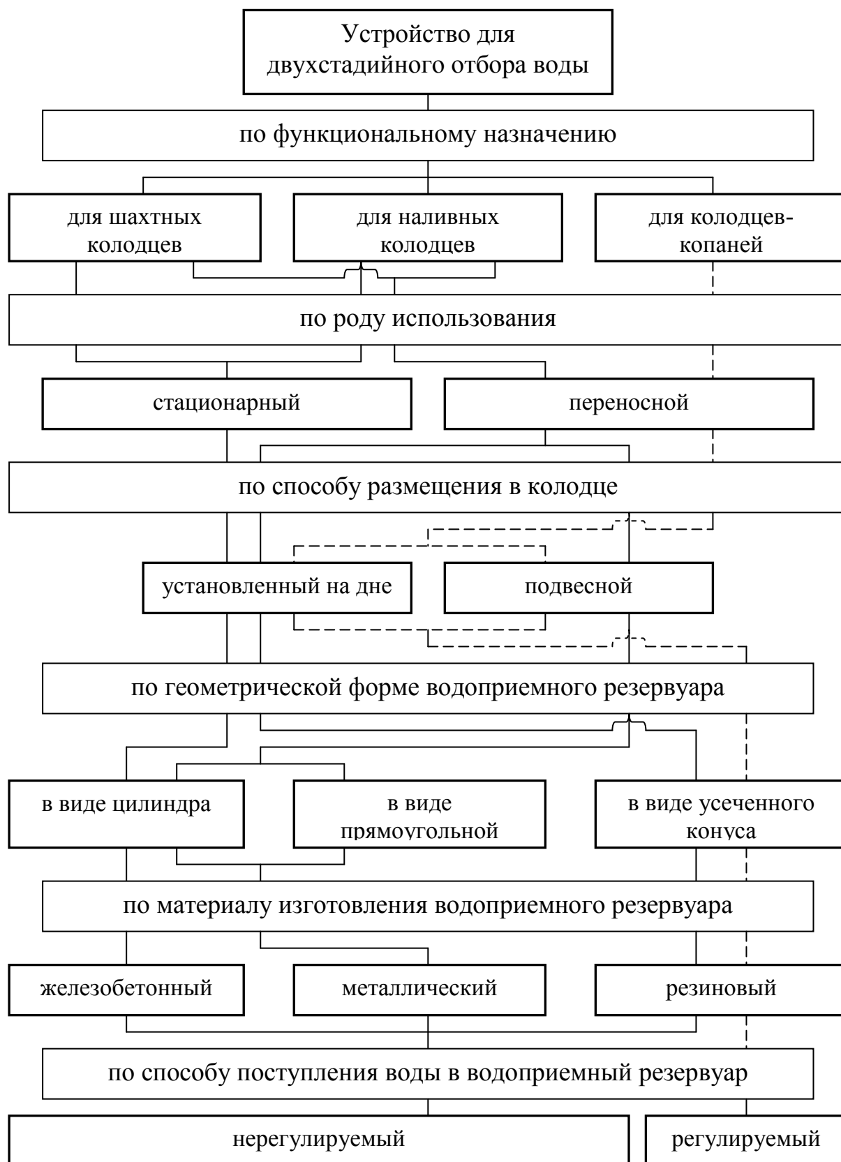
Рисунок 1.3 – Классификация устройств двухстадийного отбора воды
