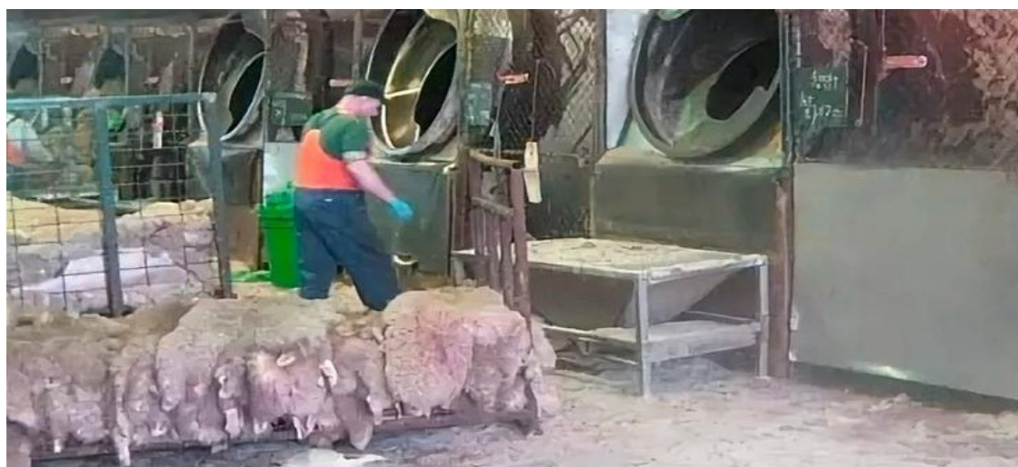
Сурет-14. Хромсыз терілерді өңдеу
