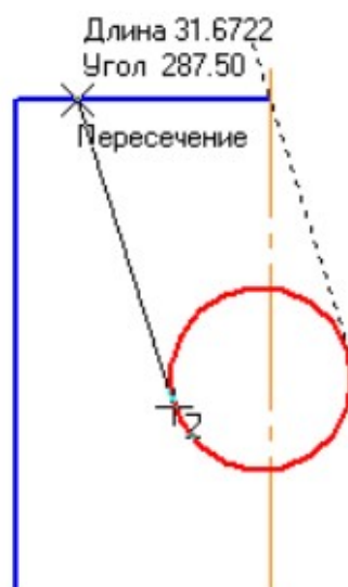
Сурет 9.3 – Ойықтың көлбеу сызығын салу процесіндегі сызба
