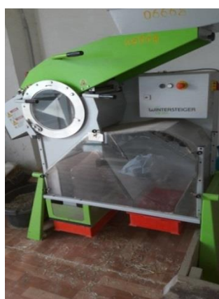
Сурет 5 – «WINTERSTEIGER» бастырғыш қондырғысы: а – жалпы – түрі; б – бастырылған дәндер
